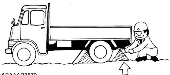
2. Mettre solidement en place les rampes munies de plaques de blocage. Fixer directement les rampes au plateau.
