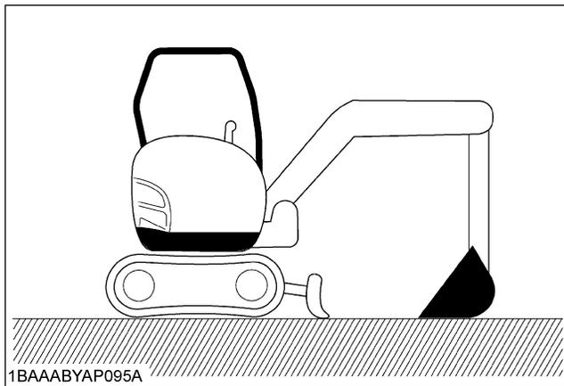
2. Vérifiez le niveau de l'huile qui doit se trouver au centre de la jauge sous une température normale (10 à 30°C (50 à 80°F)).
