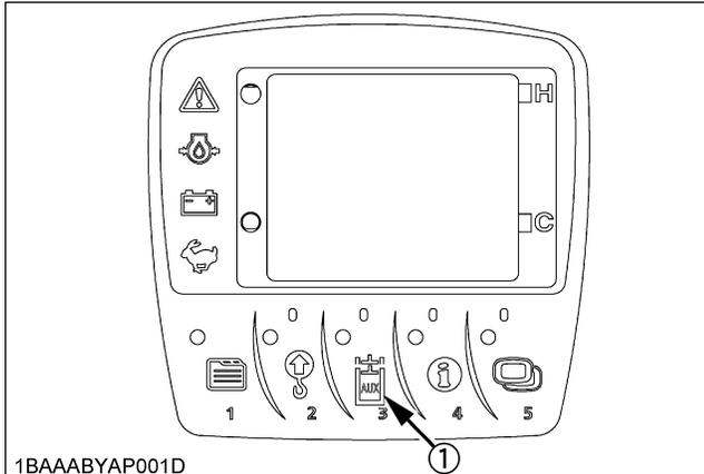
(1) Commutateur autorisant la sortie auxiliaire (Commutateur 3)
