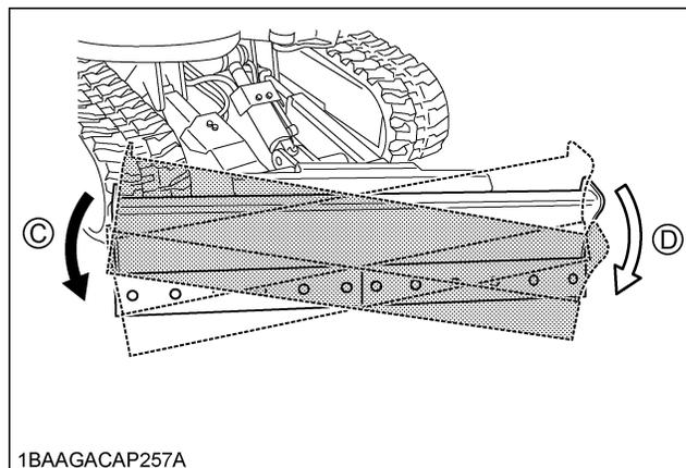
4. Appuyez sur l'interrupteur d'inclinaison à droite ou à gauche, et la lame d'inclinaison sera inclinée.
