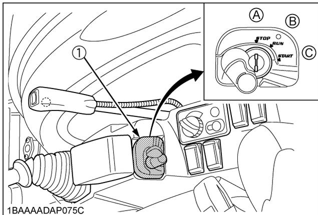
(1) Interrupteur de démarrage (A) "ARRÊT (Stop)"
