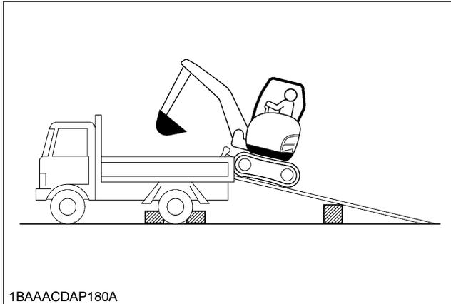
4. Aligner complètement les rampes et les chenilles avant de faire avancer lentement la pelleteuse. Après s'être assuré que les chenilles sont bien en place sur le plateau, orienter la flèche en position sur l'arrière du plateau.
