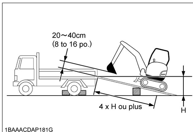
3. Pour plus de sécurité placer des cales sous l'extrémité arrière du plateau et sous les rampes.
