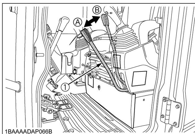
(1) Levier de verrouillage de contrôle pilote
