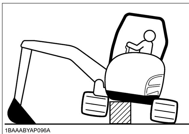
16. Ne démontez pas le ressort de tension de la chenille. Si un démontage est nécessaire, consultez votre concessionnaire KUBOTA ou un garage spécialisé. L'assemblage doit être accompli en accord avec le manuel d'atelier KUBOTA du produit impliqué.
