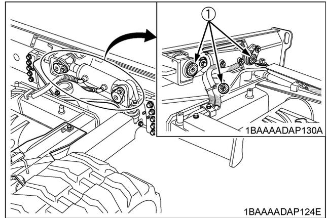
(1) Point d'appui de levage
