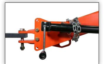
Les trous de réglage de la hauteur permettent d'installer l'attelage à une hauteur de 13,5 po à 23,75 po.
