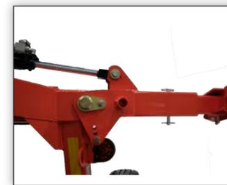
La basse pression de la glissière réglable permet de contrôler davantage la position des roues.
