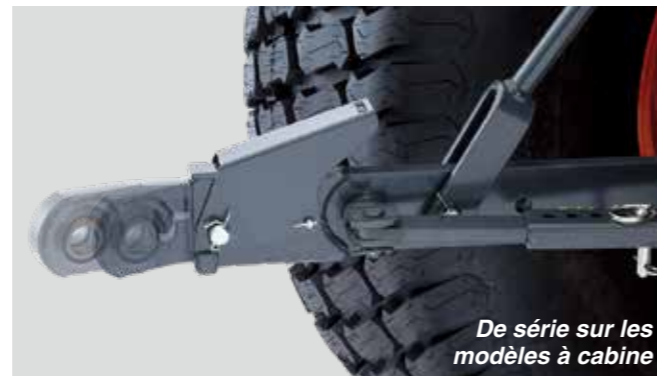
De série sur les modèles à cabine Extrémités des bras inférieurs télescopiques
