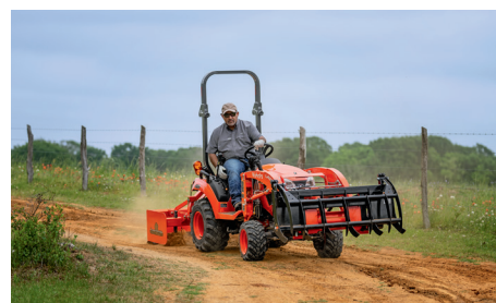
BOÎTE DE NIVELAGE
