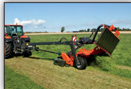
Au premier passage, le tapis est relevé et est abaissé au deuxième.
