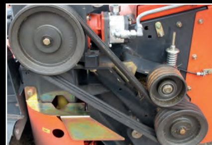
2 vitesses de rotation du conditionneur, pour une adaptation rapide aux différents fourrages et une diminution de la consommation de carburant.
