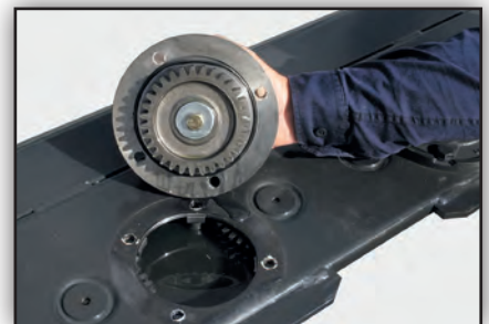
Les boîtiers de palier peuvent être retirés individuellement pour un entretien et un remplacement faciles.
