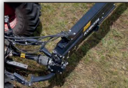
La tête pivotante offre un confort optimal lors des manoeuvres en fourrière.
