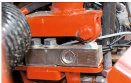
Pesons pour contrôle et application de l'engrais
