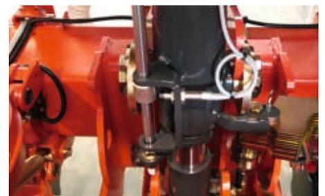
Un vérin intelligent en deux parties : suivi de terrain et levage de la machine
