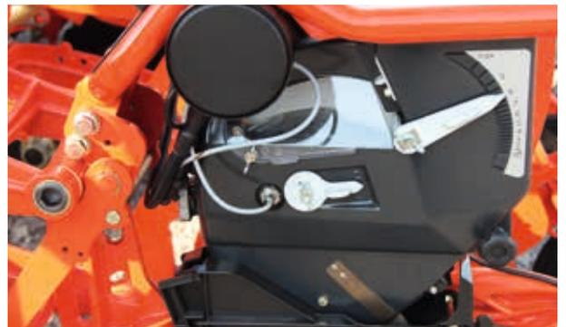
Chaque rang équipé d'un entraînement électrique e-drive Il est capable d'exécuter les fonctions GEOCONTROL et GEOSEED.
