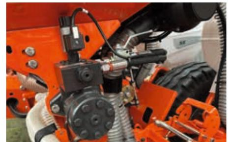
En option, l'entraînement hydraulique du fertiliseur. La dose peut être modulée en cours de travail.
