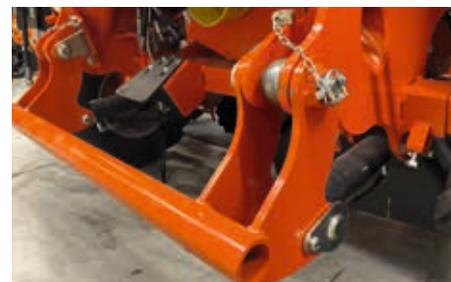
Kit de lestage hydraulique de châssis
