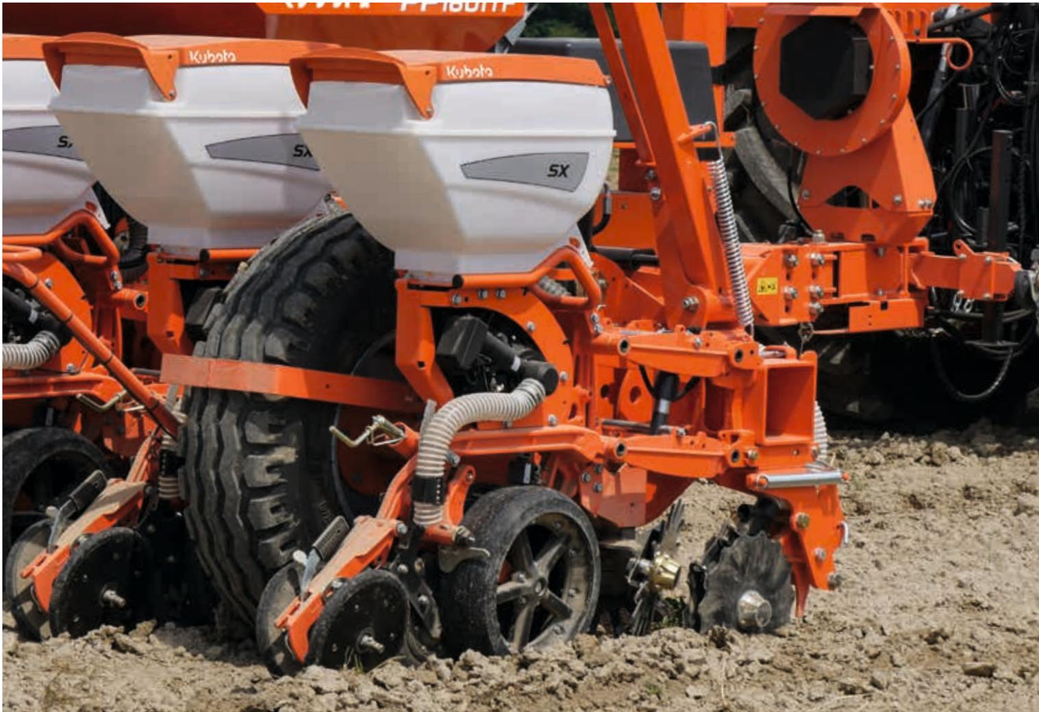
Ligne de semis SX haute vitesse jusqu'à 18 km/h.
