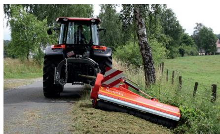
S'incline à un angle de -65 degrés.
