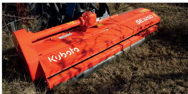
Un rouleau de 6,3 po (160 mm) de diamètre avec un racleur réglable est monté de série et assure une performance adéquate sur le terrain.
