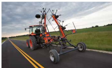
En position de transport, le poids du châssis de transport semi-portée repose sur la partie centrale de la machine et sur la barre d'attelage du tracteur.
