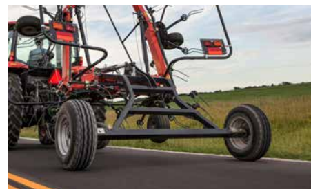
La voie large des roues de transport maintient la stabilité de la machine lors de son déplacement sur route.
