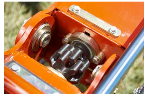
L'entraînement à doigts HexaLink Kubota permet de replier les rotors à 180° pour le transport.
