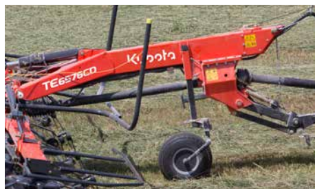
Une troisième roue permet un meilleur suivi et un fanage plus précis.
