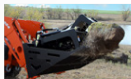
Dents en acier de calibre 80 avec pointes de dents à soufflet à l'avant.
