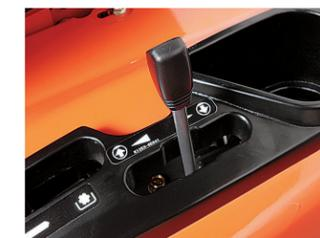
*Levier du relevage hydraulique du carter de tondeuse*
