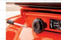
Levier de réglage de position du siège
