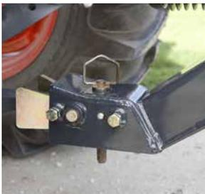
Les DM5032 et DM5040 de Kubota sont faciles à connecter à un tracteur grâce à un système simple de goupilles.
