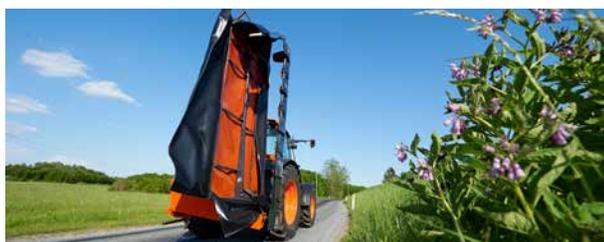
Pour le transport, la machine est repliée hydrauliquement du tracteur jusqu'à la position verticale de transport, ce qui garantit un transport stable et sûr.
