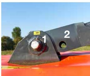
Deux options de montage pour un chevauchement optimal avec une machine montée à l'avant.
