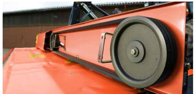
En changeant les poulies de la chaîne cinématique, il est possible de passer d'une vitesse de PDF standard de 1 000 tr/min à 750 tr/min.
