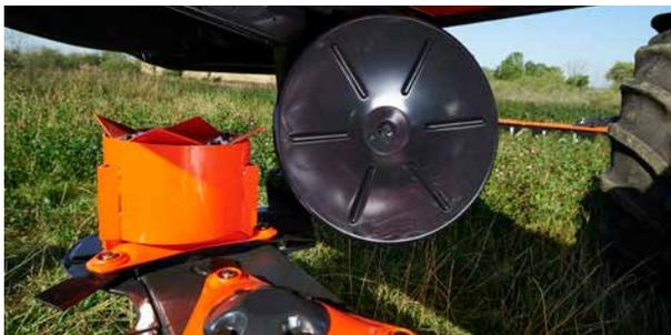
La machine peut être équipée en option de deux disques d'andainage, ce qui permet d'obtenir une largeur d'andain de 7 pi 10 po (2,4 m).
