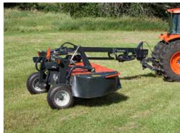
Hauteur de levage élevée pour un excellent dégagement au sol lors du transport et des manœuvres en tournière.
