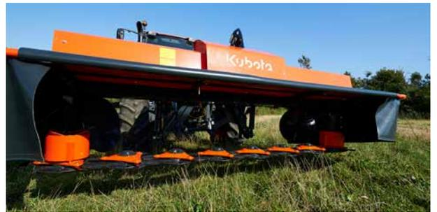
Accès facile à la barre de coupe grâce aux protecteurs avant et latéraux repliables.
