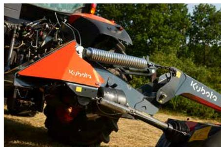
La conception à suspension centrale permet une adaptation rapide et précise aux contours du terrain.
