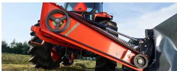
Quatre courroies en V assurent un excellent transfert de puissance.
