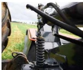
En cas d'obstacle, le système de protection anti-rupture BreakAway continue protège la barre de coupe en la faisant basculer vers l'arrière et vers le haut.
