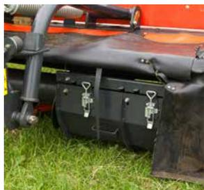
La largeur de l'andain est réglable facilement en déverrouillant les plaques d'andainage et en les faisant glisser dans la position souhaitée.
