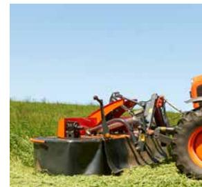
Une solution de protection antirupture intégrée dans l'avant-train permet de franchir les obstacles.
