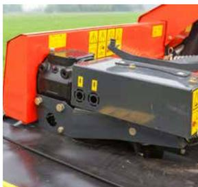
Vis sans fin est entraînée par une petite boîte d'engrenages nécessitant une puissance supplémentaire de 5 hp.
