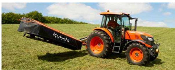
Relevage en tournière grâce à un vérin hydraulique. Aucun besoin d'utiliser l'attelage à trois points.
