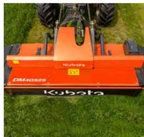
Transmission à deux vitesses de série. Vitesse de série de 1 000 tr/min. Chaîne cinématique fonctionnant à 750 tr/min et réduisant la consommation de carburant.
