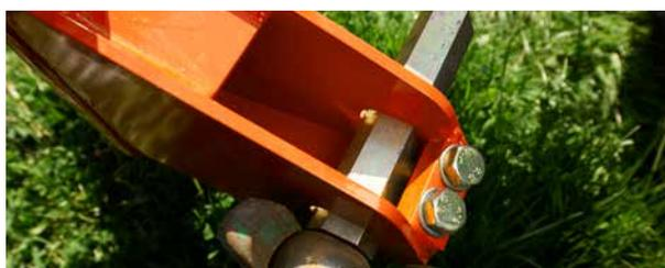
Les goupilles de tringlerie sont facilement réglés pour s'adapter à la largeur du tracteur, ce qui permet à la faucheuse de couper sur toute sa largeur de travail.
