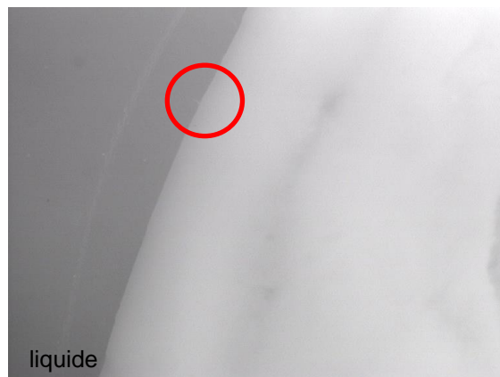
Photo 4 : Matériel de test MEZ-AEROSEAL, couleur blanche , après une période d'incubation de 28 jours avec une faible croissance des bactéries (agrandissement 50x)
