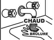
En raison du risque accru de brûlure, si la vanne de régulation de gaz du chauffe-eau est réglée à plus de 49 °C (120 °F), installer des mitigeurs thermostatiques à chaque point d'utilisation. En raison du risque accru de brûlure, ne pas régler la température des mitigeurs thermostatiques au-dessus de 49 °C (120 °F).
