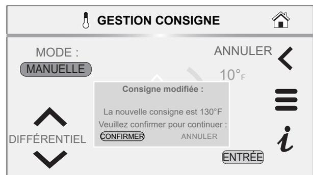
5. Pour modifier le réglage de différentiel : changer le mode automatique en manuel, puis utiliser les flèches haut et bas du différentiel pour changer sa valeur. Appuyer sur CONFIRM pour conserver les modifications ou sur CANCEL pour annuler et revenir aux réglages précédents.
