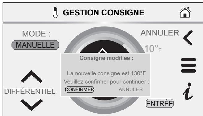
Figure 74. Température de consigne du réservoir
