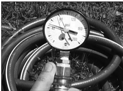
Figure 12. Utiliser un manomètre à eau pour s'assurer que la pression d'eau du domicile n'est pas trop élevée.
