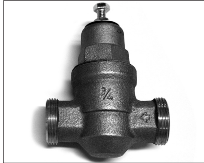
Figure 54. Un détendeur est nécessaire si la pression d'eau du bâtiment est supérieure à 552 kPa (80 psi).
