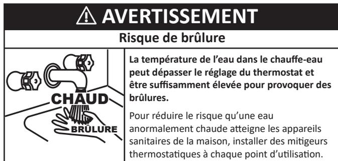
Selon une norme nationale *Performance Requirements for Water Temperature Limiting Devices (exigences de fonctionnement pour les dispositifs limiteurs de température de l'eau, ASSE 1070)* et de nombreux codes de la plomberie, la vanne de régulation de gaz du chauffe-eau ne doit pas être utilisée en tant que moyen unique de réguler la température de l'eau et d'éviter les brûlures.
