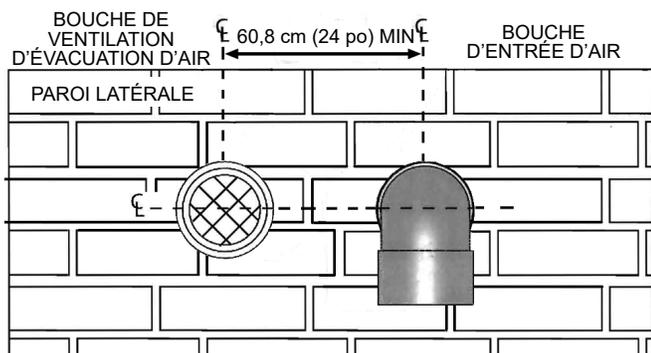
Figure 19. Séparation admission/échappement d'une évacuation murale
