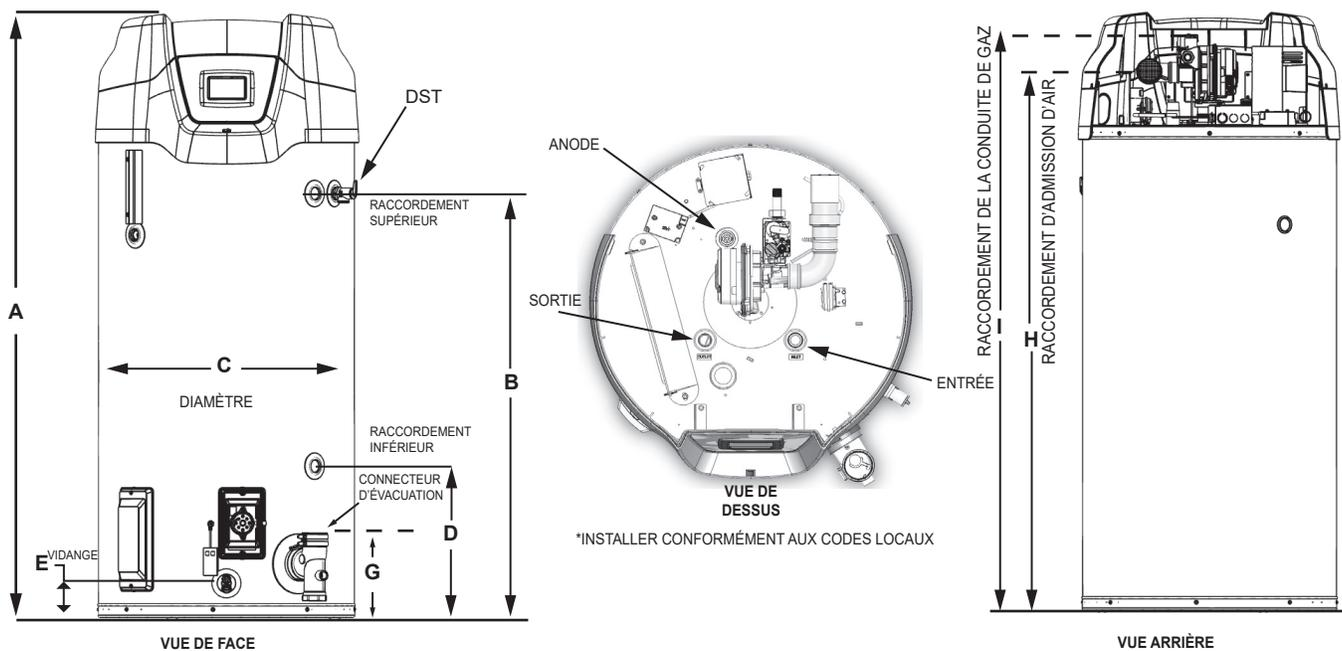
Figure 6. Dimensions de mise en place des conduites : Modèle 75 gallons
