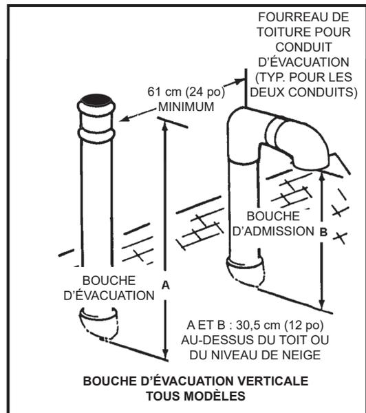
Figure 21. Dégagements des bouches d'évacuation verticales
