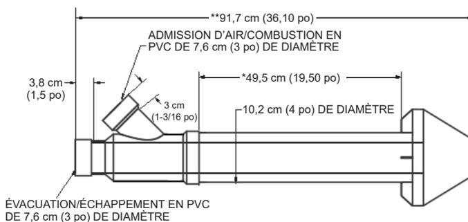
Figure 31. Pièces de la bouche d'extrémité concentrique 4 po
