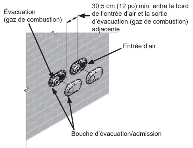
Figure 41. Dégagements de bouches compactes multiples
