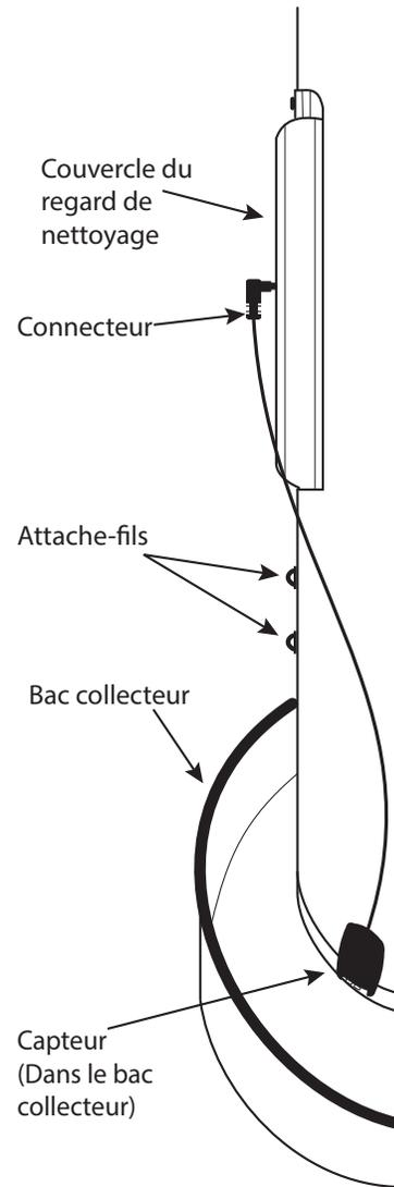
Figure 44. Installation du module de détection de fuite
