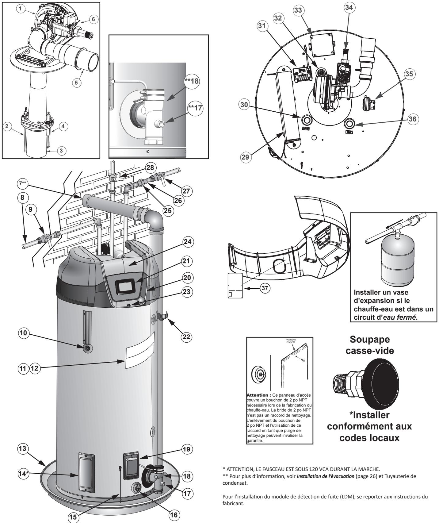
Installer un vase d'expansion si le chauffe-eau est dans un circuit d'eau fermé.
