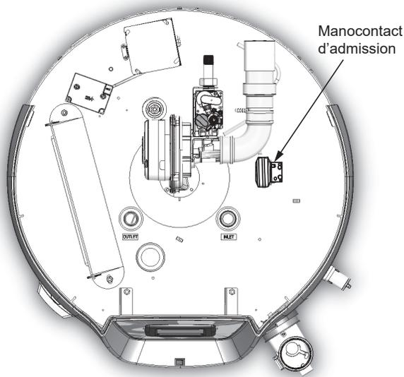
Figure 4. Manocontact d'admission sur le modèle 75 gallons
