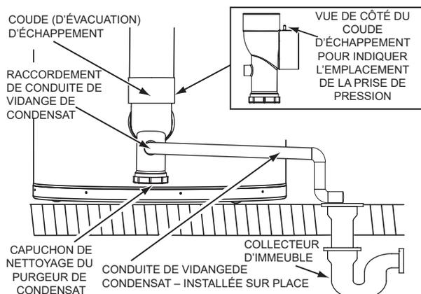
Figure 16. Configuration de la vidange de condensat
