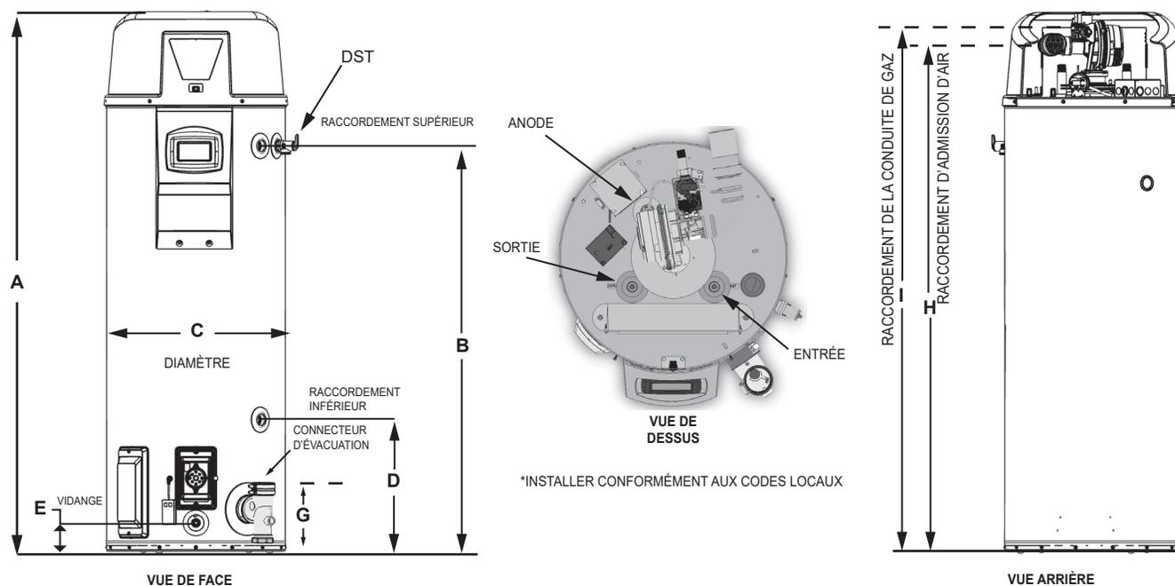
Figure 5. Dimensions de mise en place des conduites : Modèle 50 gallons
