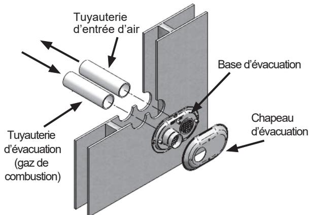
Figure 39. Composants d'une bouche d'admission/évacuation compacte
