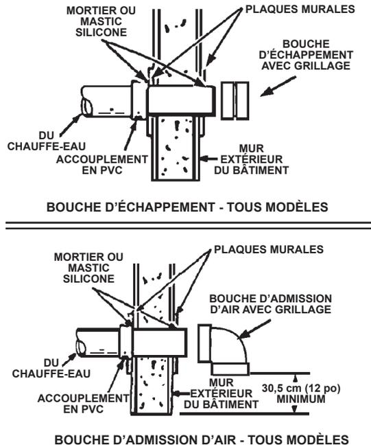
Figure 20. Installation des extrémités murales d'admission/échappement
