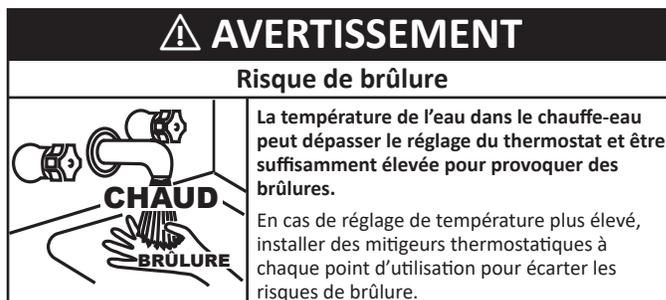
*En plus d'utiliser le réglage de température le plus bas répondant aux besoins en eau chaude, il est possible d'installer un dispositif tel qu'un mitigeur, par exemple, au niveau du chauffe-eau ou des robinets d'eau chaude utilisés par ces personnes afin de réduire la température de l'eau. Voir Figure 13 (page 22).*
