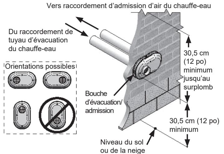
Figure 40. Dégagements d'une bouche d'admission/évacuation compacte
