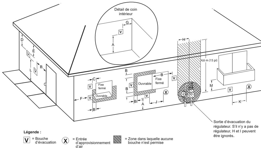
Figure 24. Système à évacuation directe utilisant l'air extérieur
