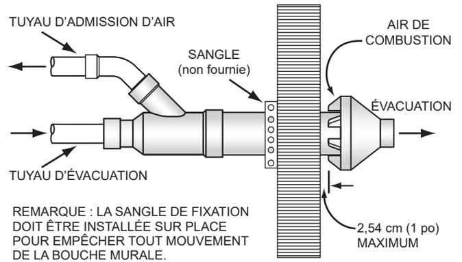
**Figure 36. Orientation et fixation d'un tuyau concentrique mural**
