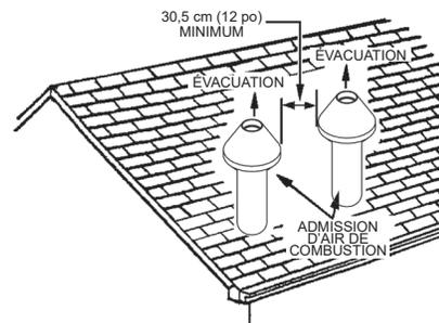
**Figure 38. Dégagements de bouches concentriques multiples de toiture**
