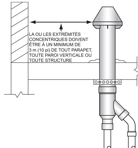
Figure 34. Extrémité concentrique - Dégagements par rapport à un parapet de toit
