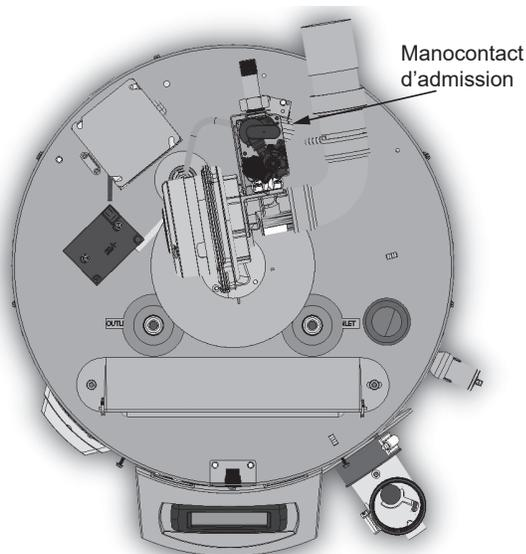
Figure 3. Manocontact d'admission sur le modèle 50 gallons
