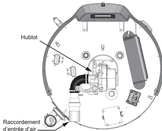
Figure 50. Emplacement du hublot - 75 gallons
