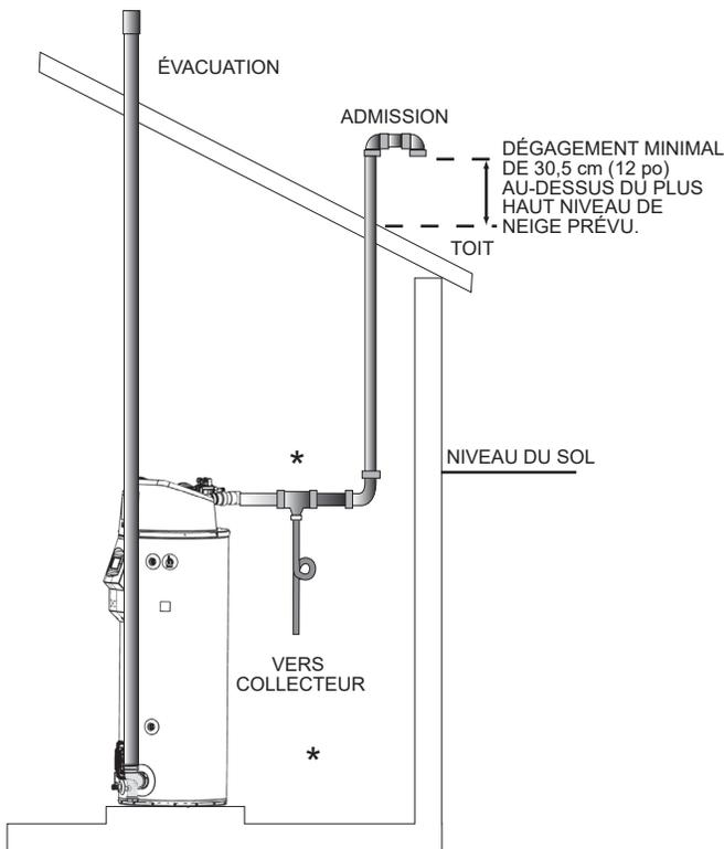
Figure 26. Évacuation directe, toit en pente, bouche d'extrémité standard
