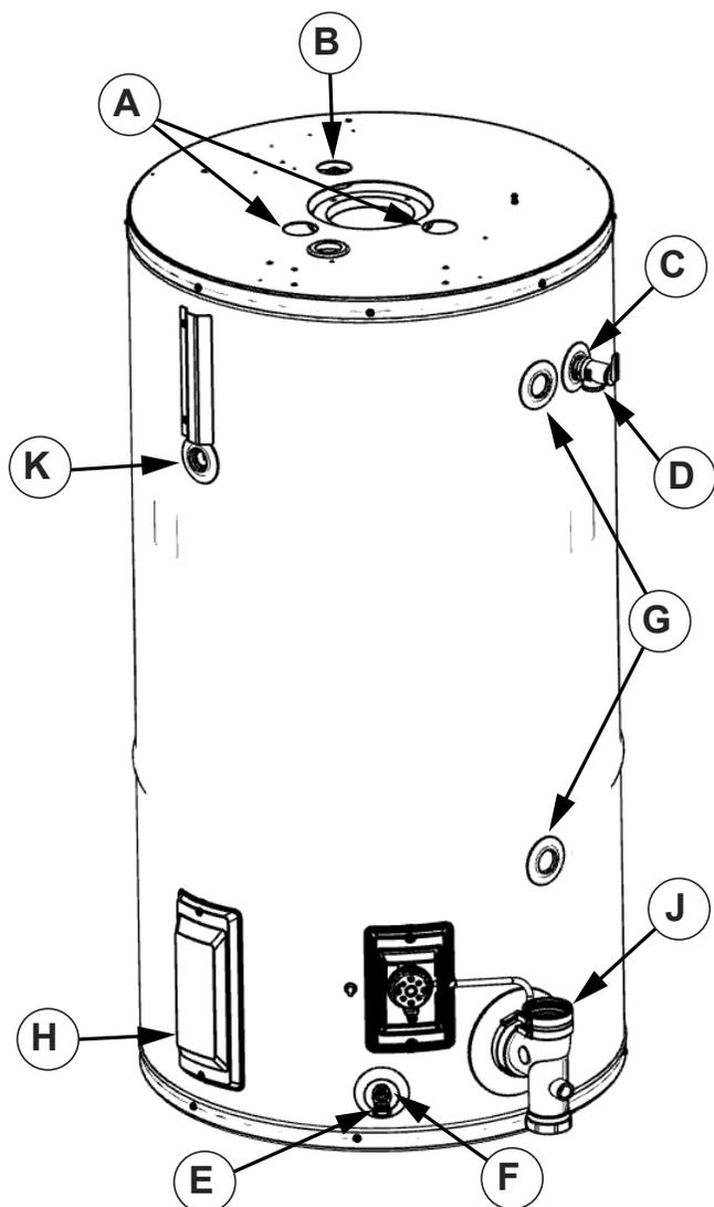
Figure 54. Points de contrôle de l'étanchéité
