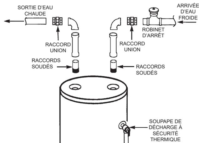
Figure 15. Configuration type de la tuyauterie d'eau
