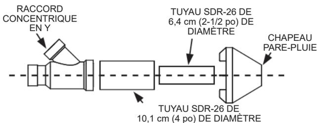
Figure 30. Pièces de la bouche d'extrémité concentrique 2 po
