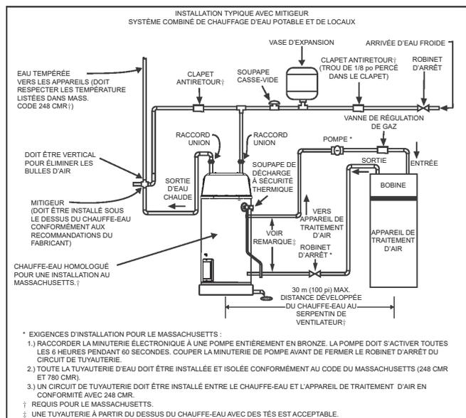
Figure 14. Installation typique avec mitigeur et chauffage de locaux
