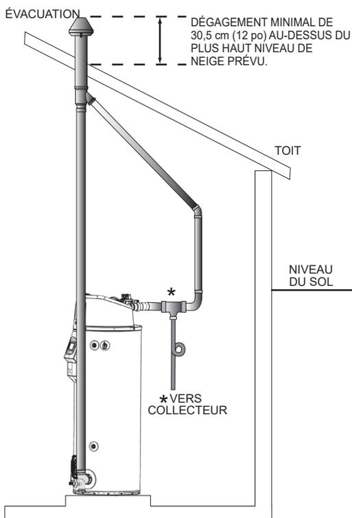
Figure 27. Évacuation directe, toit en pente, bouche d'extrémité concentrique
