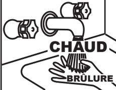
**La température de l'eau dans le chauffe-eau peut dépasser le réglage du thermostat et être suffisamment élevée pour provoquer des brûlures.**
