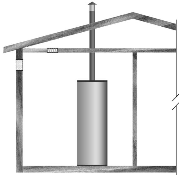
Figure 10. Air extérieur à travers une ouverture
