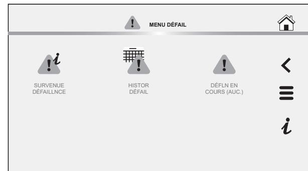
Cet écran contient le message d'erreur de la défaillance ou de l'alerte en cours. L'heure à laquelle la défaillance ou l'alerte s'est produite s'affiche directement en dessous. Une courte description de la cause de la défaillance ou de l'alerte s'affiche en dessous.
