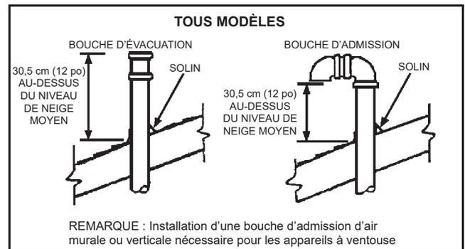
Figure 22. Dégagements pour la neige des bouches d'évacuation verticales sur toit en pente
