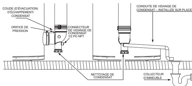
Figure 42. Installation de la vidange de condensat
