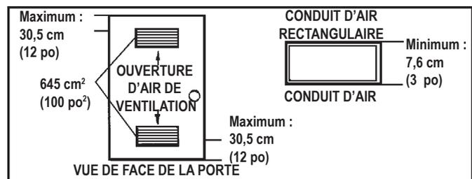
Figure 8. Air de combustion et ventilation
