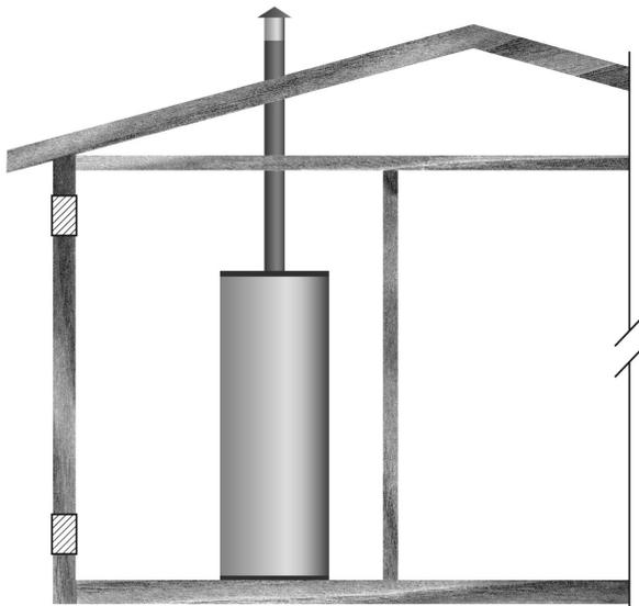
Figure 9. Air extérieur à travers deux ouvertures
