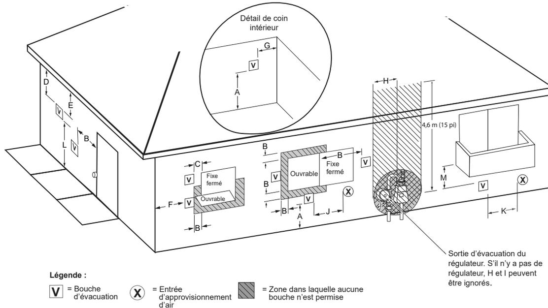
Figure 25. Système autre qu'à évacuation directe utilisant l'air extérieur
