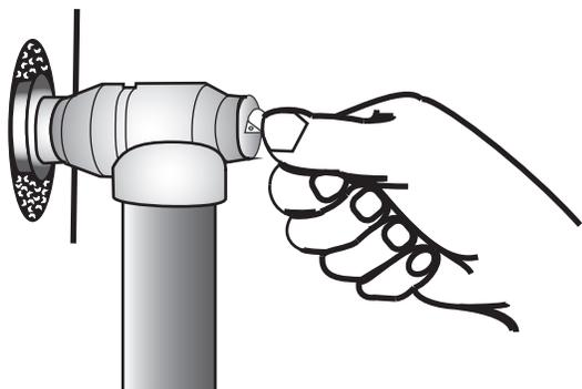
Figure 52. Essai de la soupape de décharge à sécurité thermique
