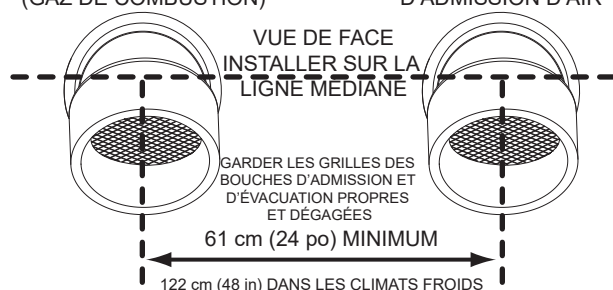
Figure 38. Extrémité murale - Évacuation directe
