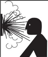
Le réglage ou l'augmentation de la pression sur une cuve visiblement corrodée ou endommagée peut faire exploser la cuve et provoquer des dommages matériels et des blessures graves, voire la mort. Remplacer les cuves corrodées ou endommagées avant de régler ou d'augmenter la pression du circuit. Seuls des professionnels qualifiés peuvent vérifier, régler ou réinitialiser la pression de précharge de la cuve.
