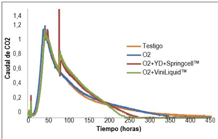
El uso de ViniLiquid™ en comparación con el producto seco recombinado totalmente equivalente (Derivado de levadura DL + SpringCell™ cortezas de levadura) muestra mejores performances en términos de fermentación completa debido a la asimilación directa de los nutrientes que le permite su formulación líquida.
