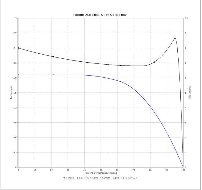
Performance : 208-230/460 V 60 Hz 6P Rated current : 389-352/176 A Moment of inertia (J) : 5.63 kgm<sup>2</sup> **LRC** : 6.2 Duty cycle : Cont.(S1) : 90.6 kgfm Insulation class Rated torque : F : 240 % Locked rotor torque Service factor : 1.15 Breakdown torque : 260 % Temperature rise : 80 K Rated speed : 1185 rpm Design : B
