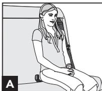
2. Retirez la sangle du baudrier de la partie supérieure du dossier du siège. Ne laissez pas la ceinture s'entortiller. (Le baudrier pourrait possiblement se verrouiller trop rapidement par-dessus le corps. Si cela se produit, laissez légèrement rétracter la ceinture pour la déverrouiller. Tirez ensuite la ceinture devant vous plus lentement.) **B**
