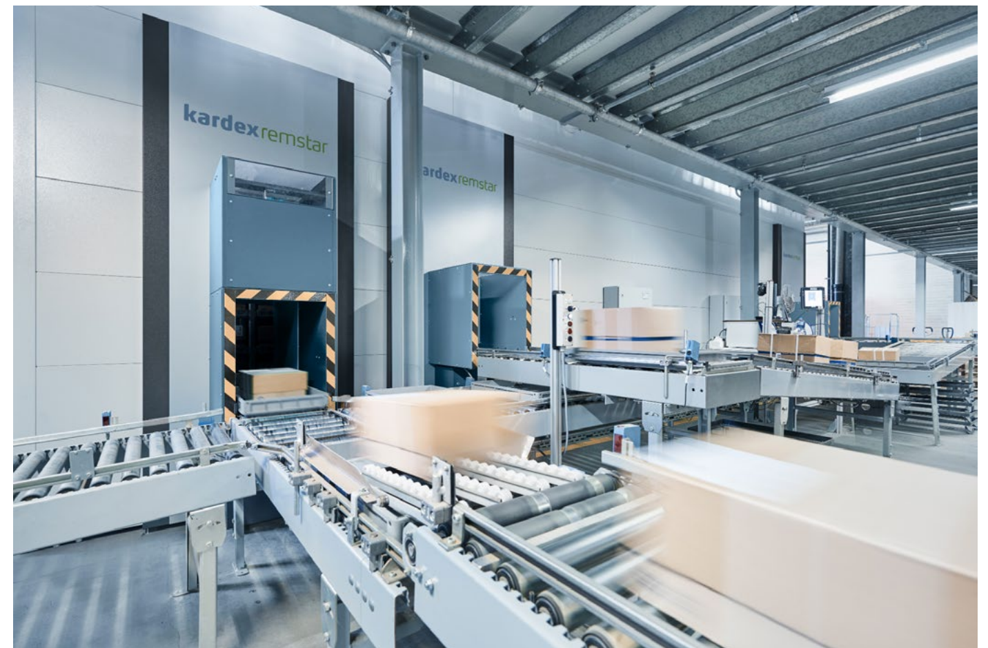
Eine fortschrittlichere Einrichtung zur Auftragskonsolidierung kombinierte das Miniload-in-a-Box mit Förderbändern zu einem System, den die automatische Verteilung der Behälter übernimmt.
