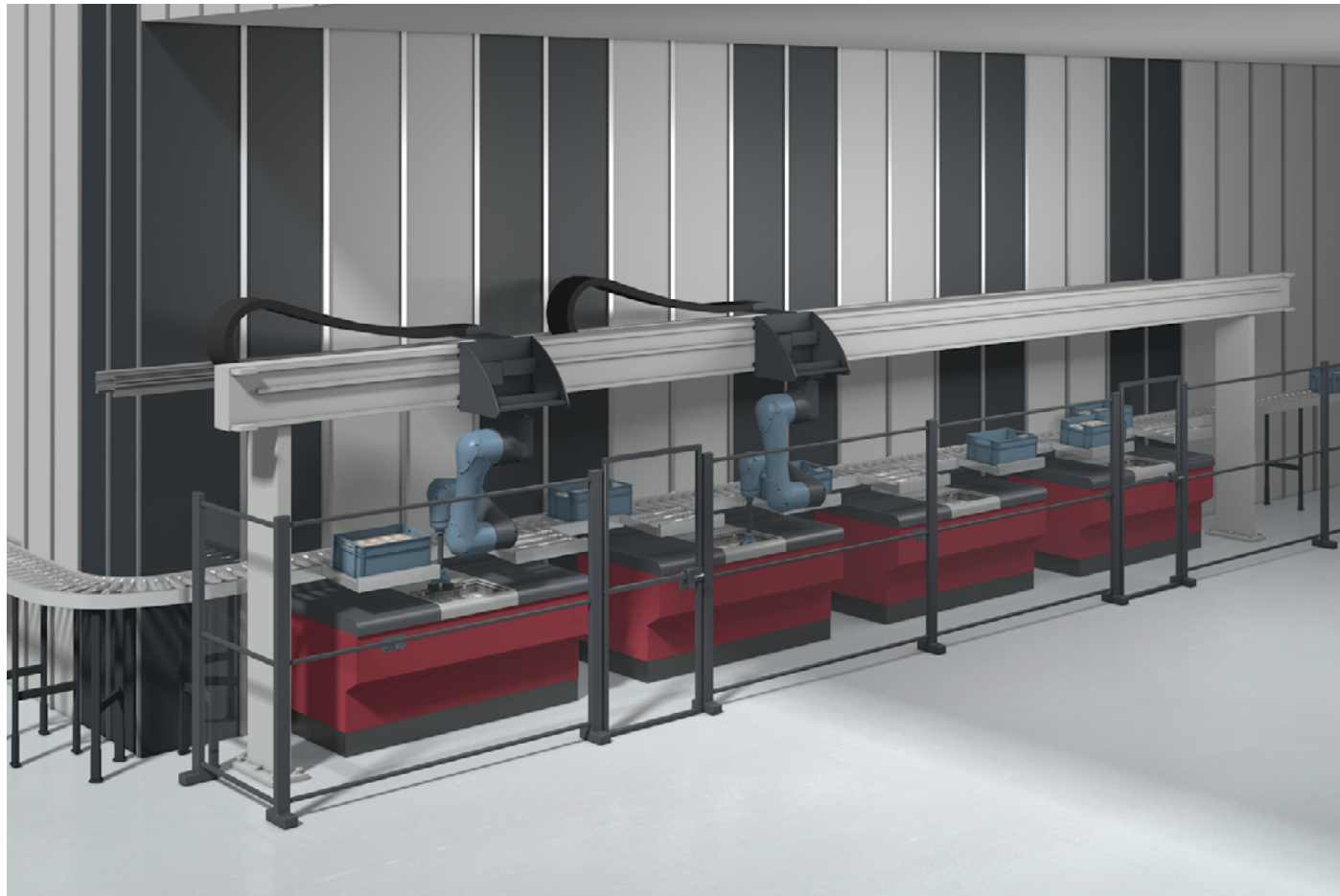
Automatizované řešení s robotikou pro vyzvednutí a umístění za účelem vychystávání
