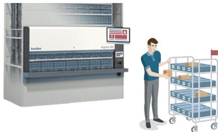
Die Lagersysteme stellen die benötigten Artikel bereit und zeigen an, welche Menge zu entnehmen ist und in welchen Behälter auf dem Kommissionierwagen diese gelegt werden müssen.
