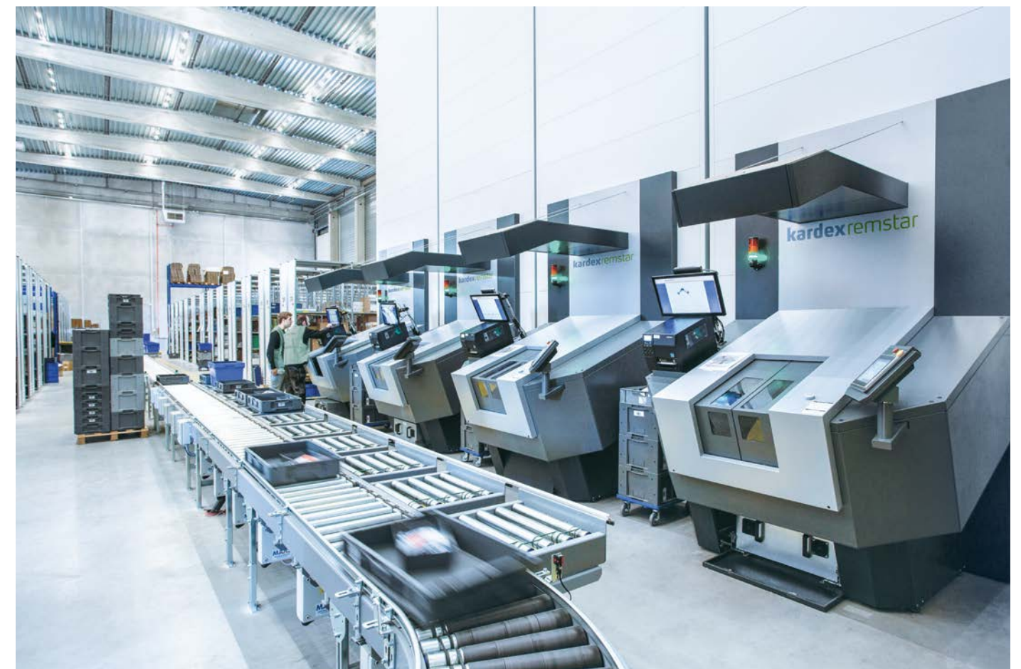
Kommissionierung mit Drehtischen und Fördertechnik mit Ablageplätzen
