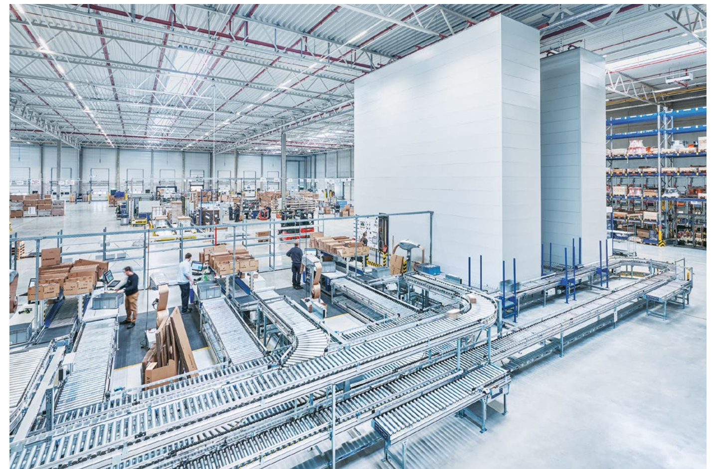
Vertical Buffer Module Kardex Miniload-in-a-Box* mit automatischen Fördertechnikanschlüssen
