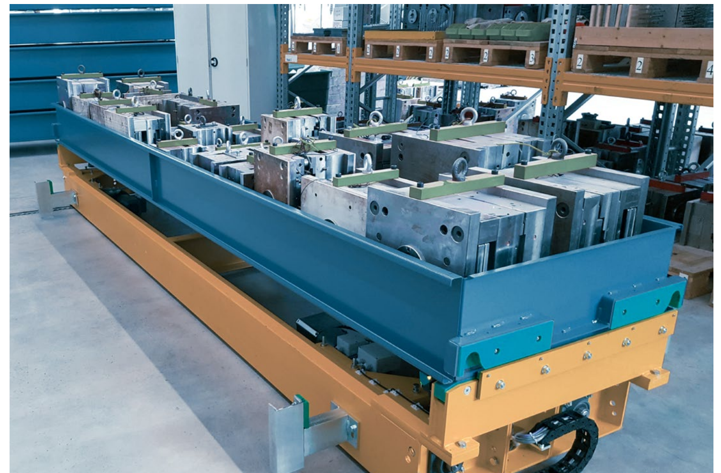
Lagerung von Formen und Werkzeugen, Traglast 5.000 kg pro System-Kassette
