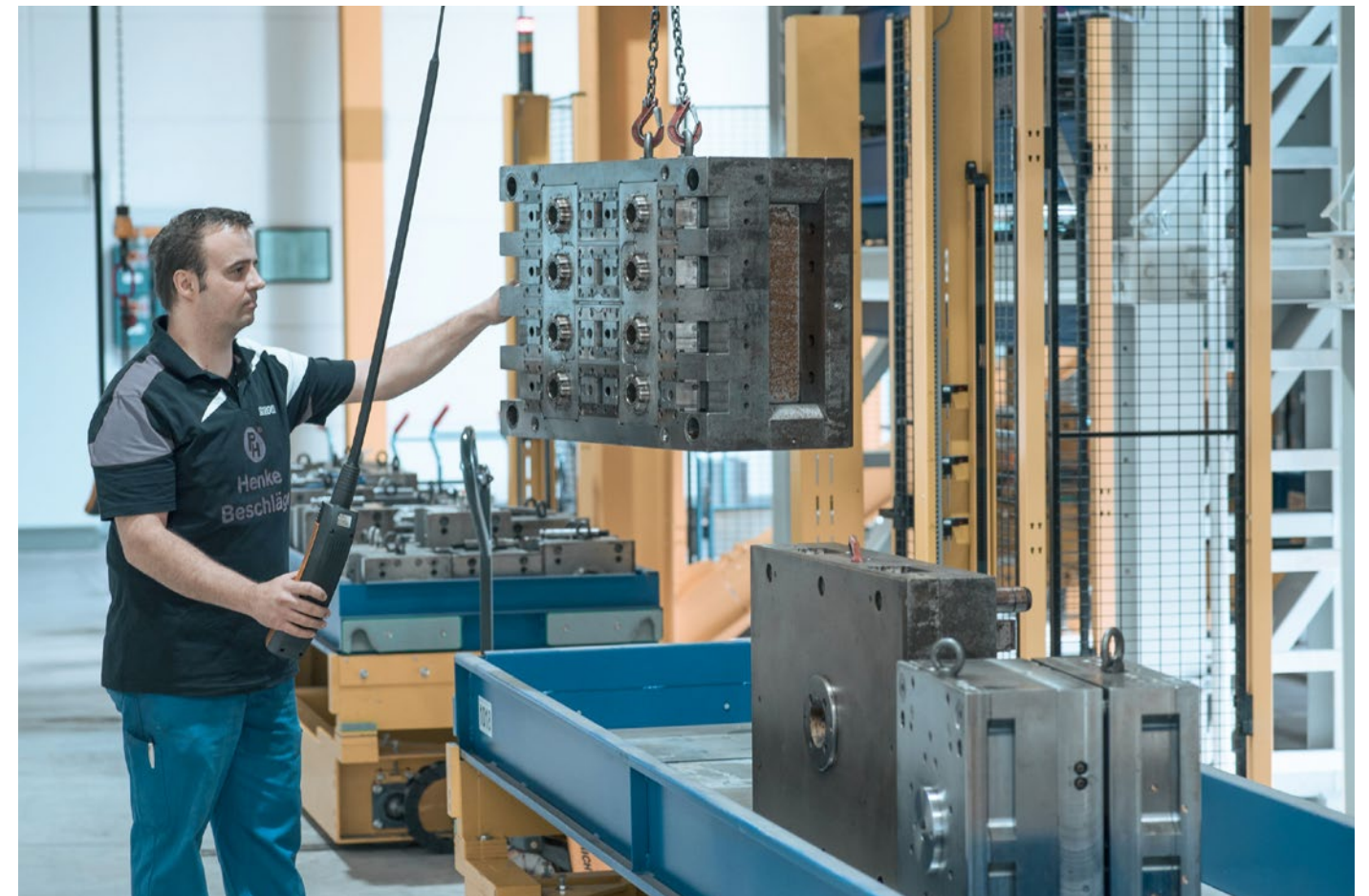
Sicheres Be- und Entladen mithilfe eines Hebemittels oder Krans
