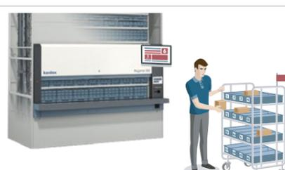
5 L'ASRS en question fournit les articles demandés et indique le nombre d'articles à prélever et à déposer dans chaque compartiment (commande) du chariot.
