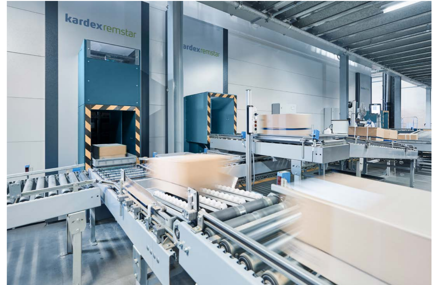
Otomatik konveyör bağlantısı ile sipariş konsolidasyonu
