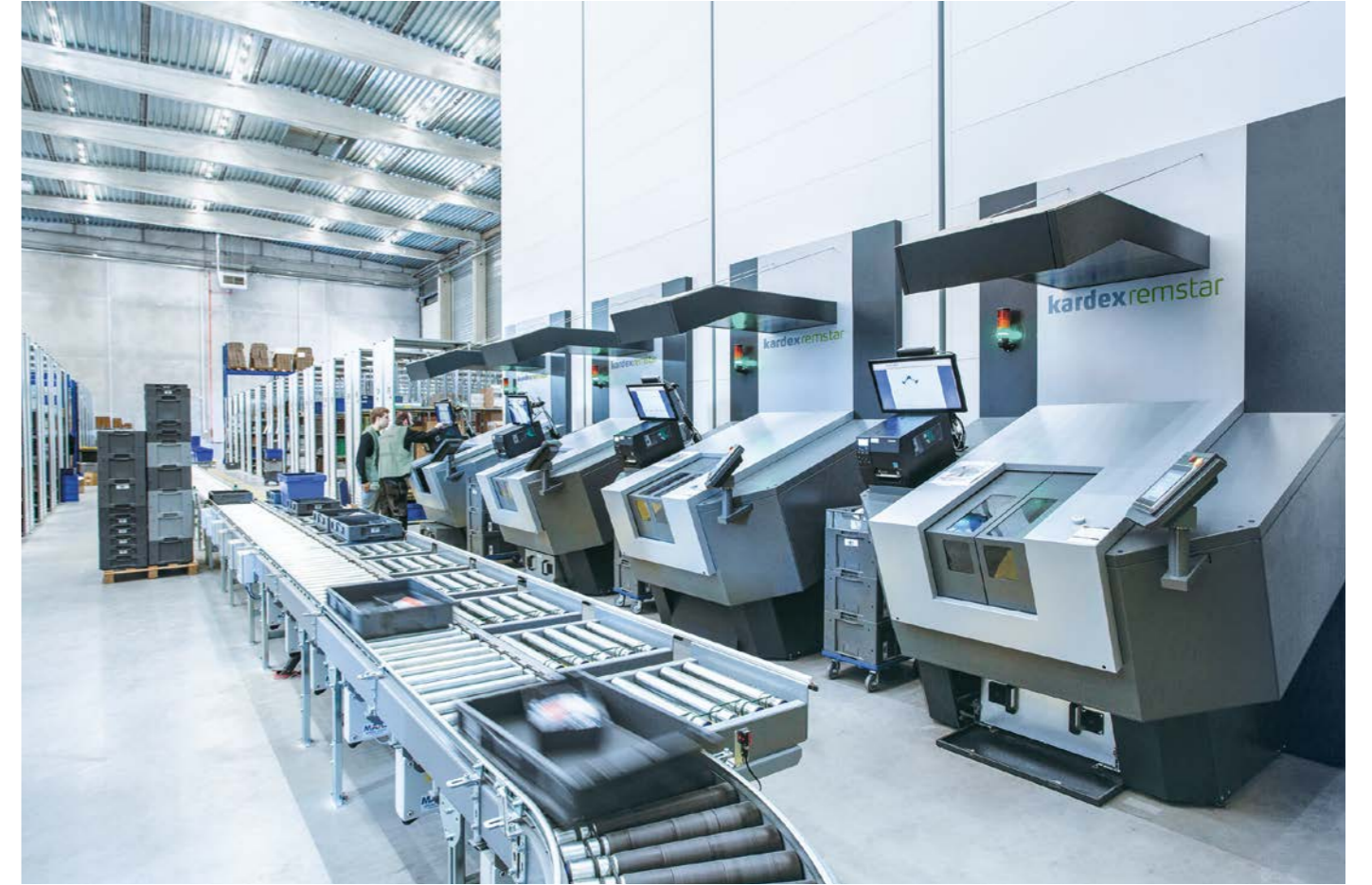
Döner tablalar ve yerleştirme konumlarına hakim bir konveyör sistemi ile sipariş toplama
