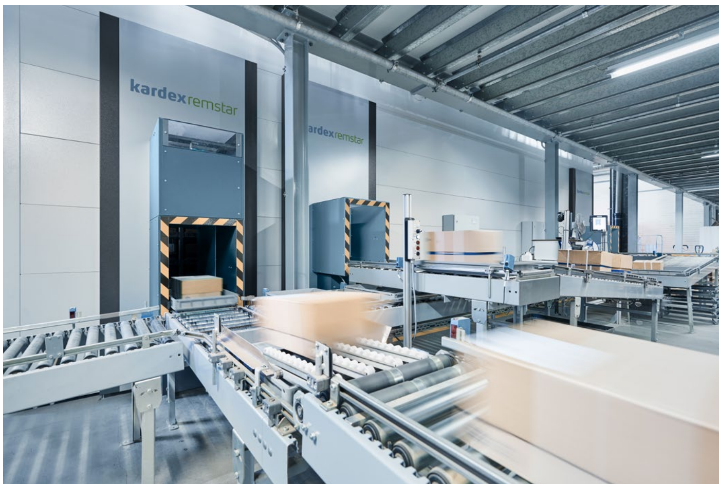
Uma configuração mais avançada de preparação de pedidos com bandas transportadoras a gerir automaticamente a distribuição dos pedidos.
