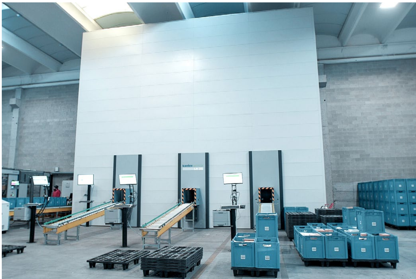
O Kardex Miniload-in-a-Box serve como um buffer de preparação simples com três aberturas de caixas ou bandejas plásticas.
