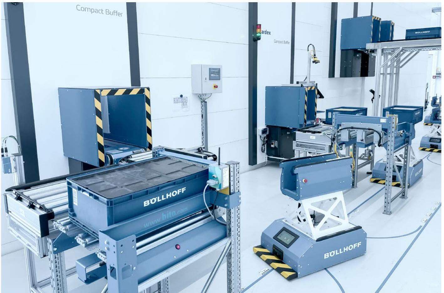
Armazenamento e recuperação automatizados com AGVs
