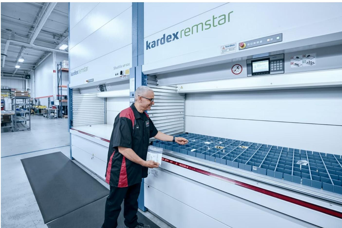
Armazenamento e recuperação automatizados com Kardex Shuttles
