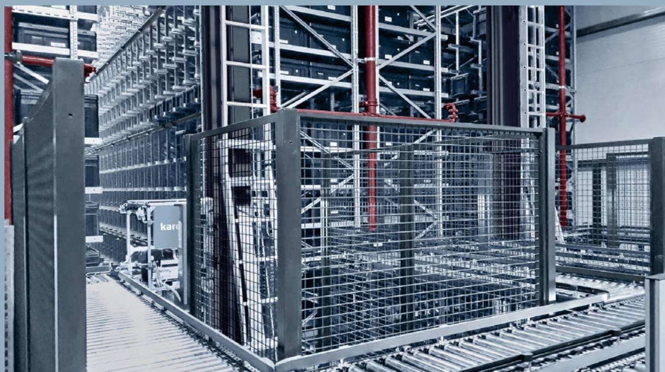
Il existe également des solutions standard, comme le Kardex Miniload-in-a-Box. Cette solution couvre un large éventail d'applications de systèmes automatiques de stockage et de mise à disposition et convient parfaitement comme solution de stockage tampon, de kitting ou de préparation de commandes.
