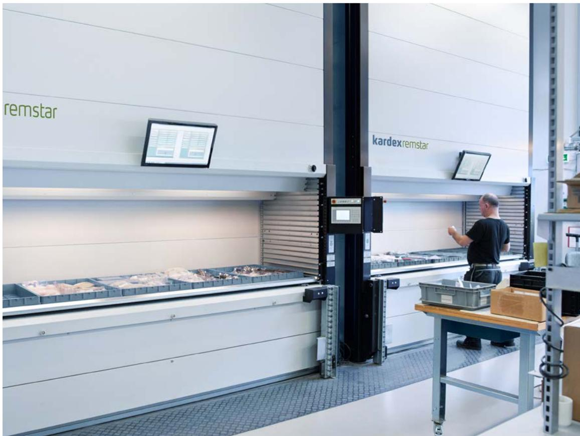
Os Vertical Lift Modules consistem em duas colunas de prateleiras com um extrator mecânico posicionado no centro. O extrator viaja para cima e para baixo entre as prateleiras armazenadas, localizando-as e recuperando-as automaticamente conforme necessário – semelhante a um elevador com portas que se abrem tanto à frente como atrás.
