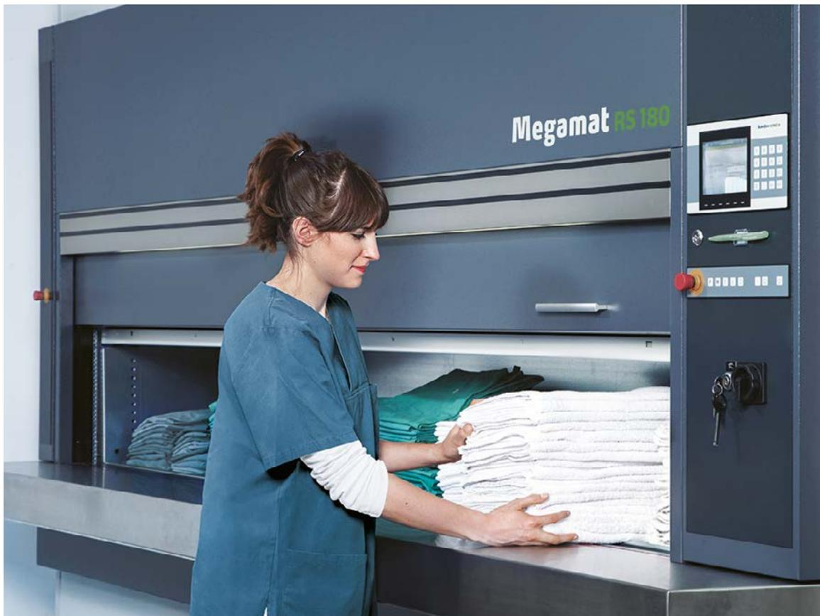
Os Vertical Carousel Modules são construídos com uma série de caixas plásticas ou bandejas plásticas ligadas em locais fixos a uma unidade de corrente. Um motor movimenta as caixas plásticas ou bandejas plásticas num circuito vertical, em ambos os sentidos, para frente e para trás.
