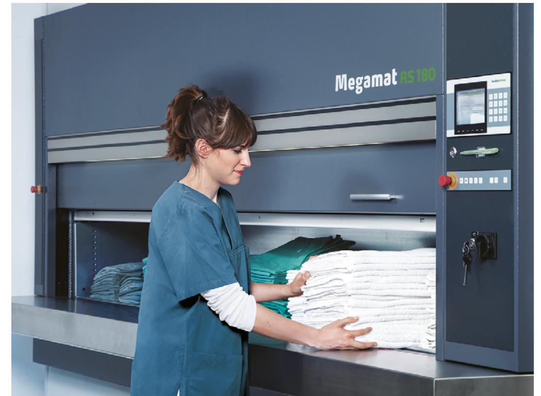
Les carrousels verticaux, Vertical Carousel Module (VCM) sont un ensemble de plateaux de stockage reliés à une transmission par chaîne. Le mouvement est actionné par un moteur qui déplace les plateaux dans une boucle verticale en marche avant ou en marche arrière, comme une grande roue.
