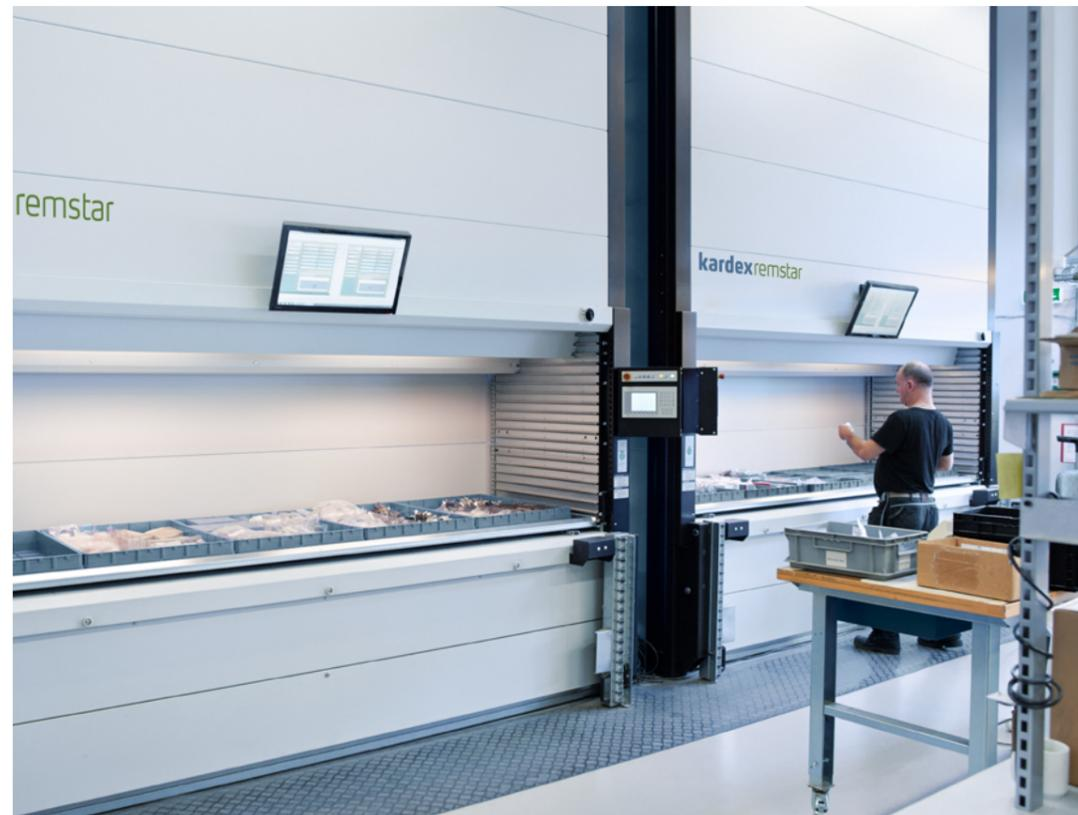
Les tours de stockage verticales, Vertical Lift Module (VLM) sont composées d'un système clos dans lequel des plateaux sont disposés verticalement à l'avant et à l'arrière de la machine, avec une navette ou élévateur placé au centre. Le dispositif de navette se déplace vers le haut et le bas entre les plateaux stockés, en les localisant et les distribuant automatiquement dans des ouvertures d'accès aux plateaux.
