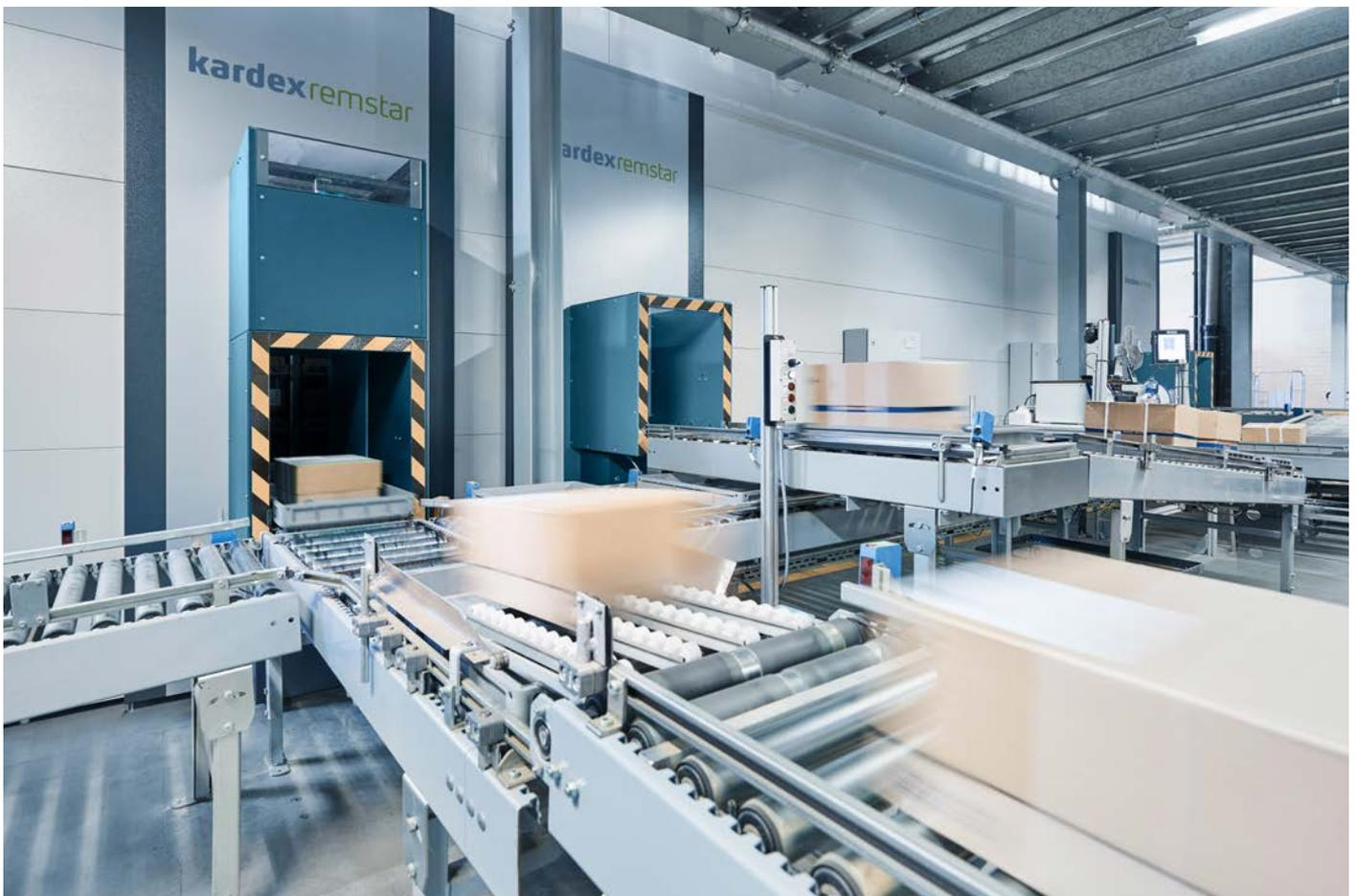
Consolidação de pedidos com conexão a um sistema transportador automático
