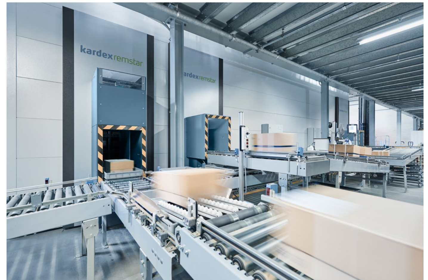
Bardziej zaawansowana konfiguracja konsolidacji zamówień z taśmociągami automatycznie obsługującymi dystrybucję pojemników.
