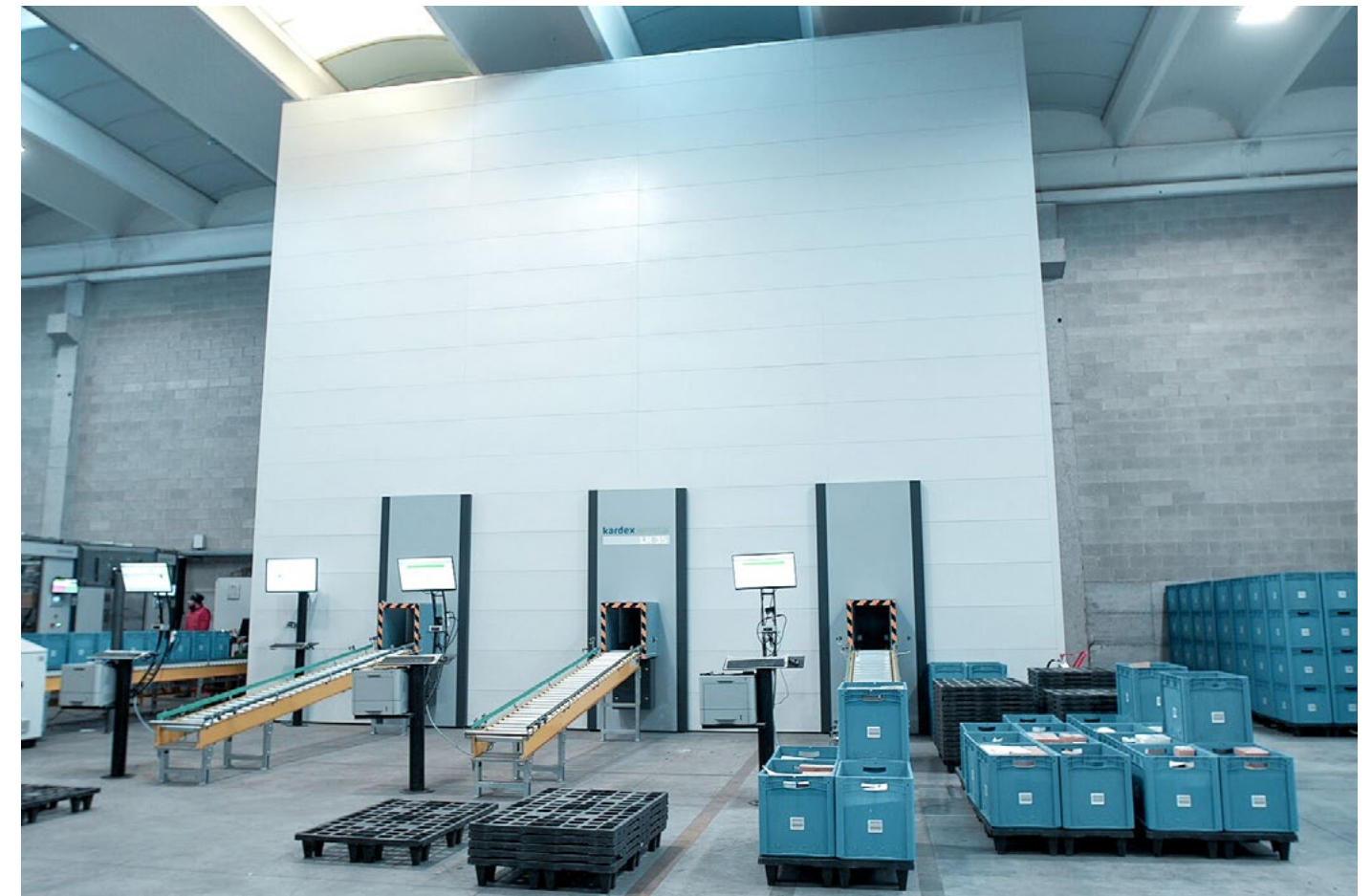
Kardex Miniload-in-a-Box działa jako prosty bufor konsolidacji z trzema otworami na pojemniki.
