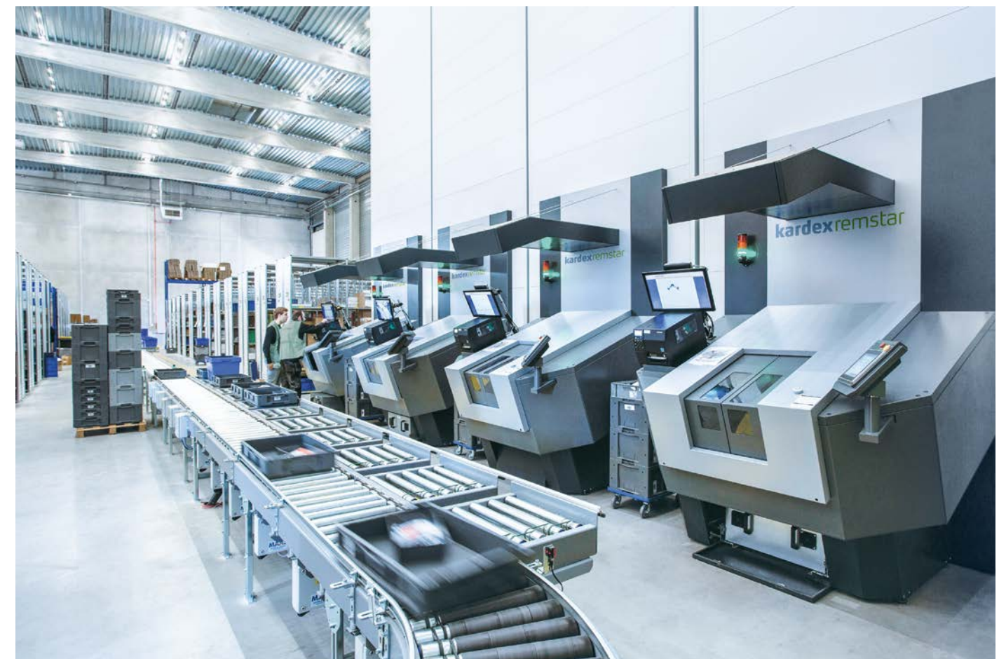
Order picking met draaischijven en een transportbandsysteem met putlocaties
