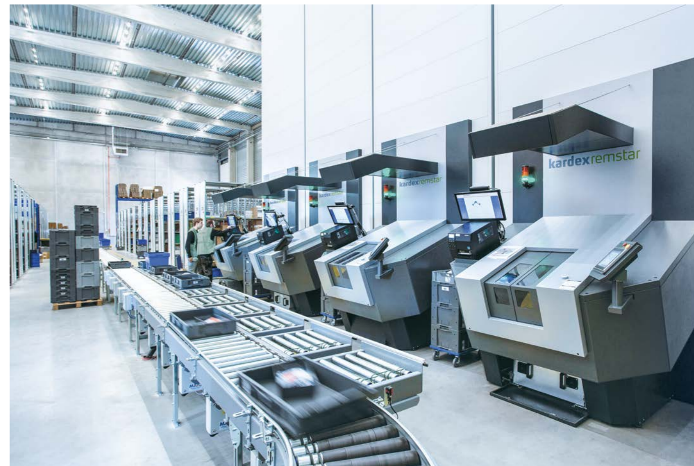
Vychystávání objednávek pomocí otočných stolů a dopravníkového systému s místem uložení
