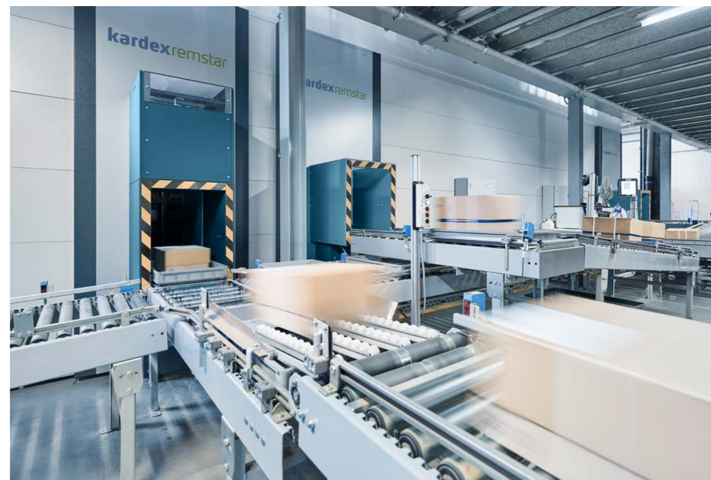
Konsolidace objednávek s automatickým připojením dopravníku
