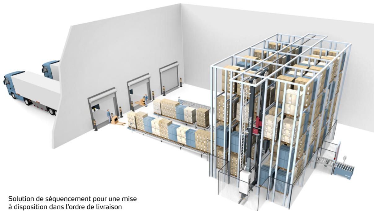
Solution de séquencement pour une mise à disposition dans l'ordre de livraison
