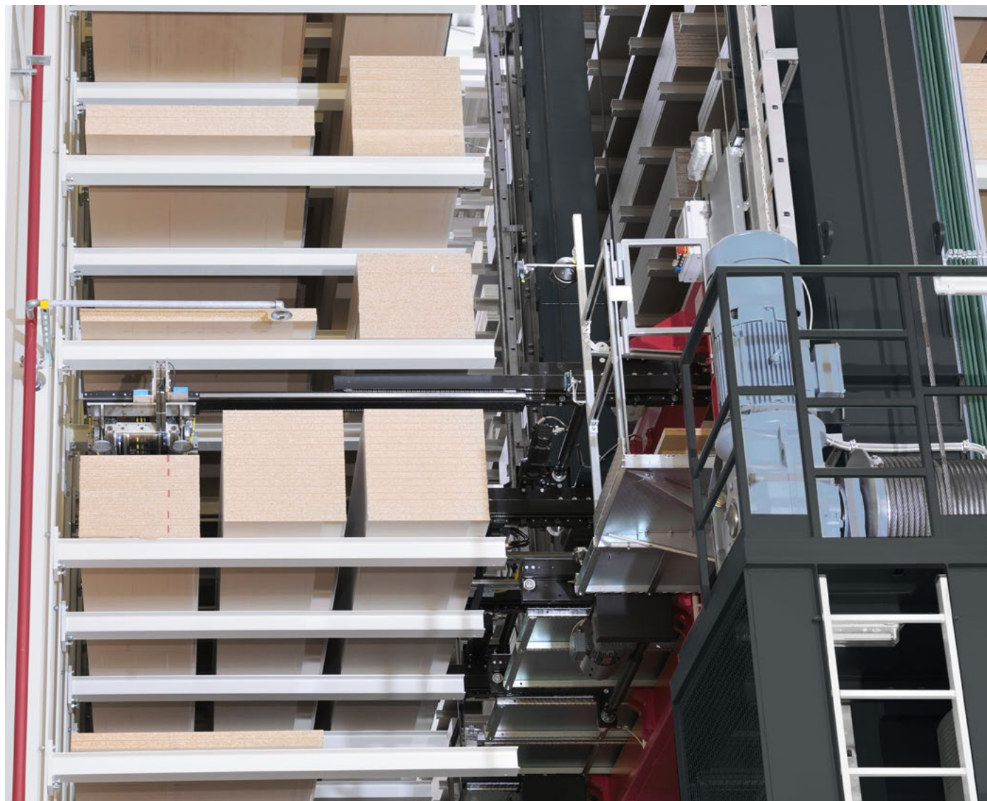
De platen worden in het magazijn direct en zonder beschadiging met een vacuümheffer verzameld
