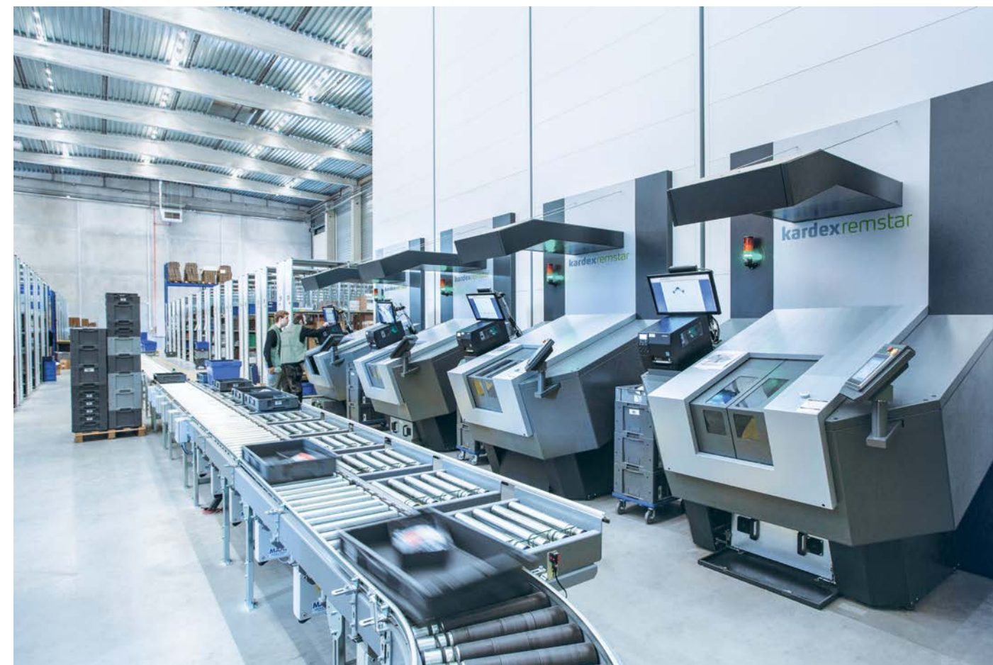
Picking con plataformas giratorias y un sistema transportador con ubicaciones de colocación
