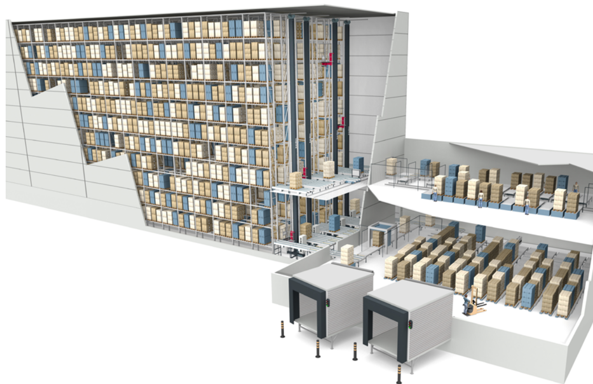
Zautomatyzowany magazyn mroźniczy
