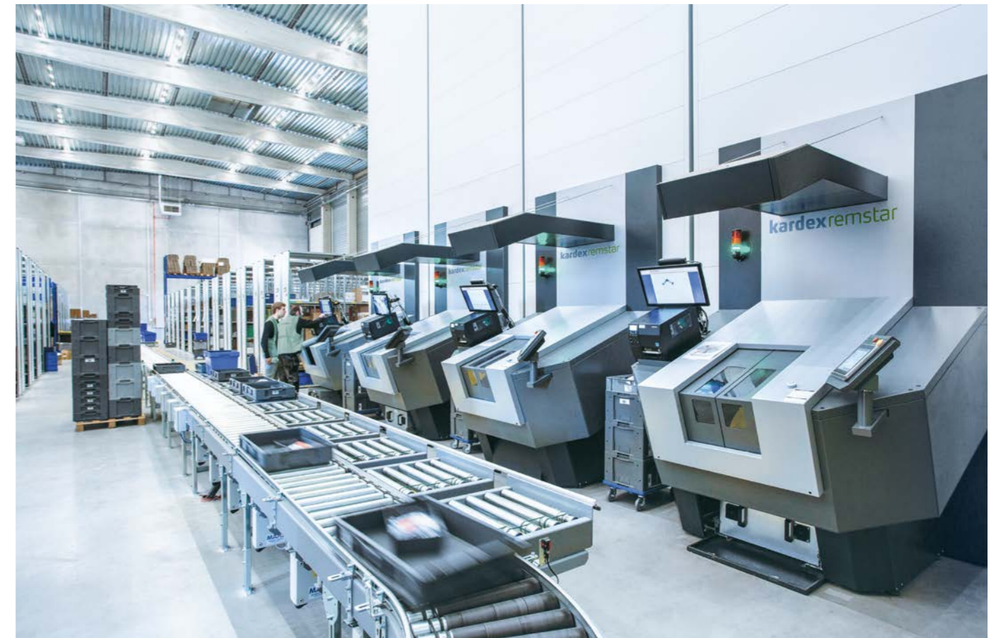
Kompletacja zamówień za pomocą stołów obrotowych i układu przenośników z określonymi lokalizacjami odkładania
