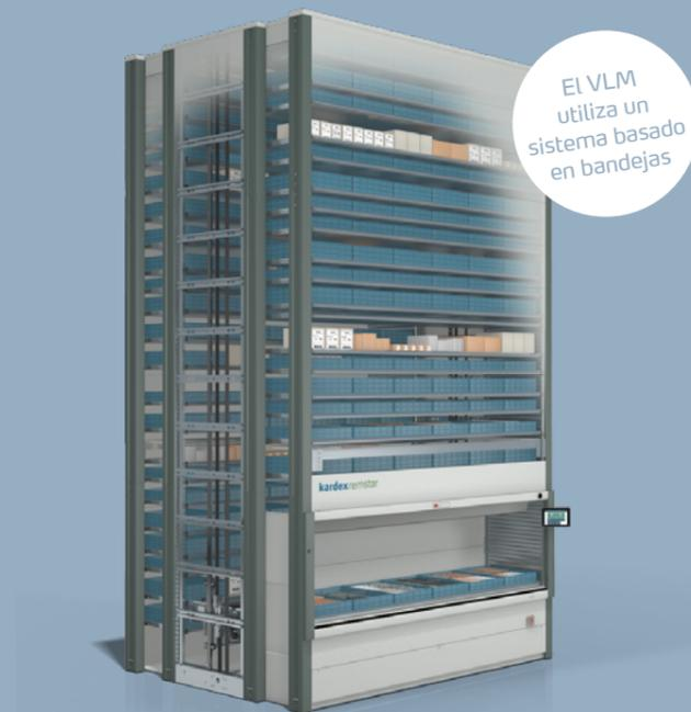
Un Vertical Lift Module (VLM) está formado por dos columnas de bandejas con un mecanismo automatizado de introducción/extracción en el centro. El mecanismo de introducción/extracción se mueve verticalmente entre las bandejas almacenadas, localizándolas y retirándolas automáticamente cuando es necesario, como un ascensor con una puerta delante y otra detrás.
