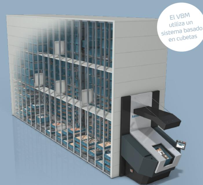
Un Vertical Buffer Module (VBM) consiste en un pasillo rodeado por un sistema de estantes de varios segmentos en el cual trabaja una columna móvil con una pinza telescópica. El controlador de la unidad pone en movimiento la pinza, que recoge una caja/cubeta y la transporta hasta una estación de picking.
