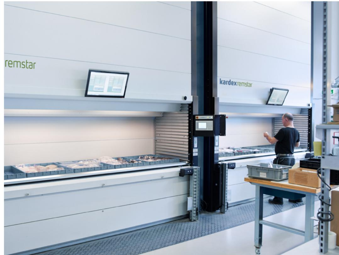
Un Vertical Lift Module está formado por dos columnas de bandejas con un mecanismo de introducción/extracción en el centro. El mecanismo de introducción/extracción se mueve verticalmente entre las bandejas almacenadas, localizándolas y retirándolas automáticamente cuando es necesario, como un ascensor con una puerta delante y otra detrás.
