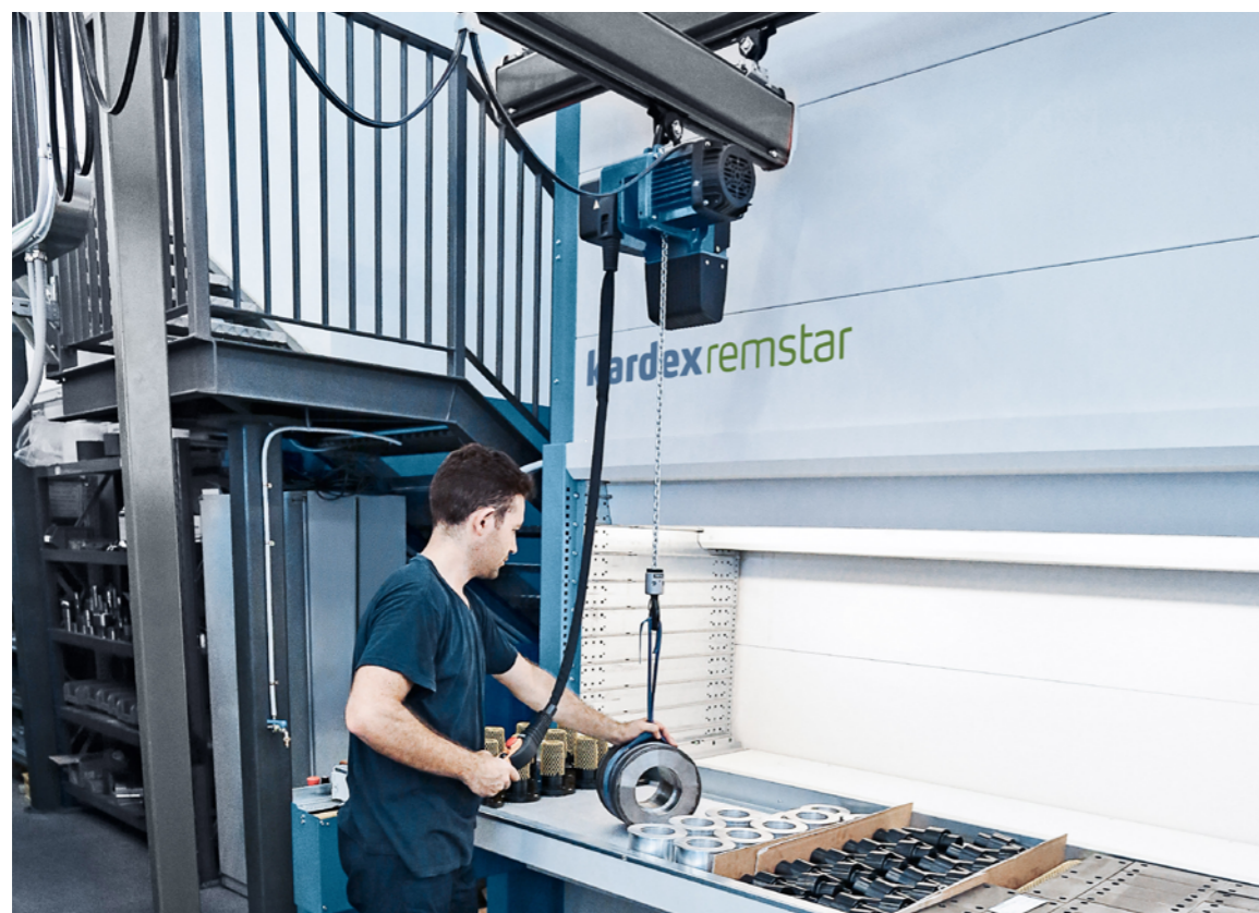
Tour de stockage verticale Kardex Shuttle avec palan de levage intégré
