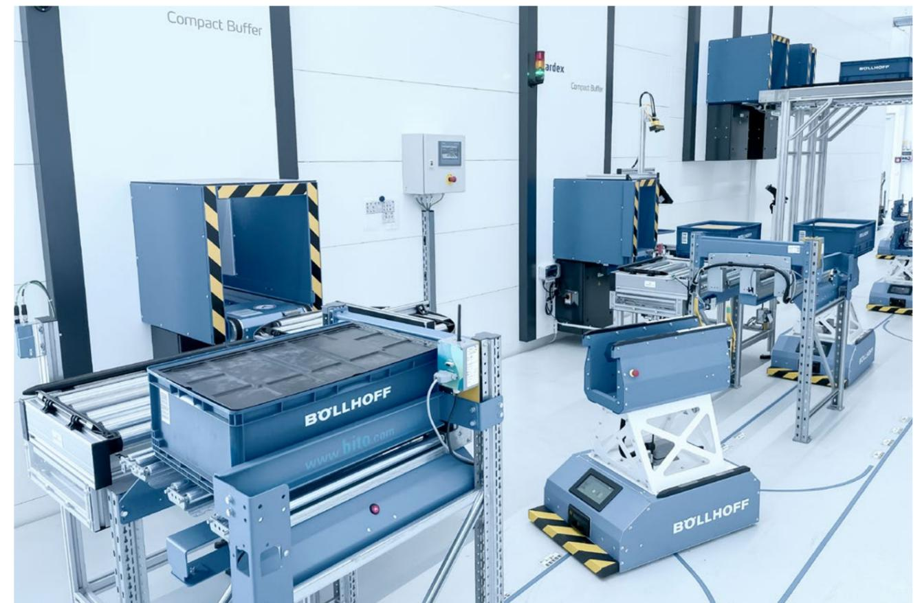
Stoccaggio e prelievo automatizzati con gli AGV
