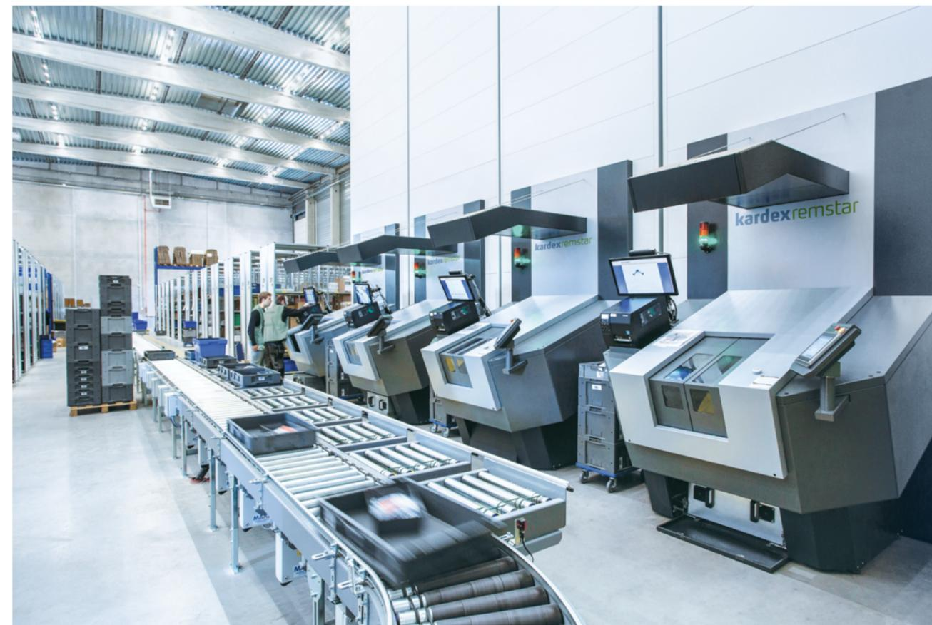
Picking degli ordini con turntable e sistema a nastro trasportatore con posizioni di inserimento
