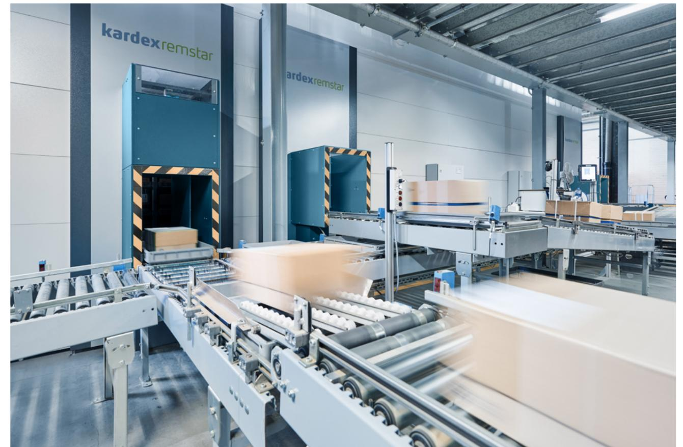
Consolidación de los pedidos con conexión a un sistema transportador automático
