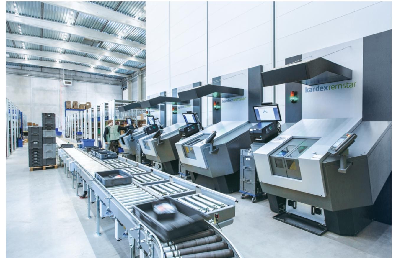
Picking con plataformas giratorias y un sistema transportador con ubicaciones de colocación
