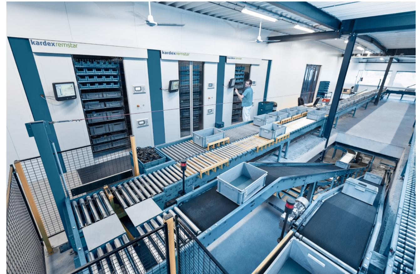
Kardex Horizontal Carousel avec système de convoyage
