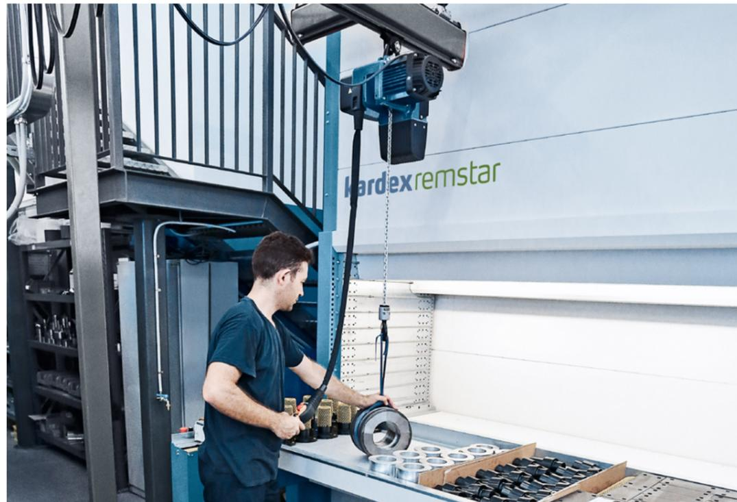
Vertical Lift Module Kardex Shuttle con grúa integrada
